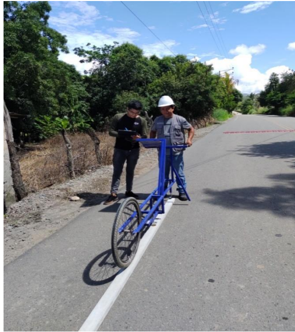
Figura 23: Lectura para la Calibración del Equipo km 4+000.00 - 7+444.00
