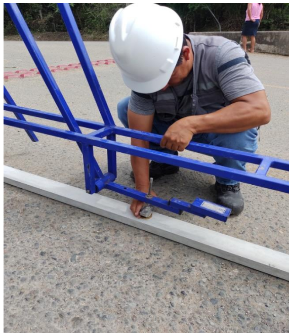
Figura 18: Colocación de la Pastilla para la Calibración del Equipo
