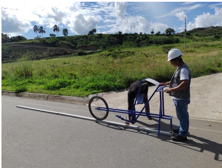
Figura 30: Lectura para la Calibración del Equipo Carril Izquierdo
