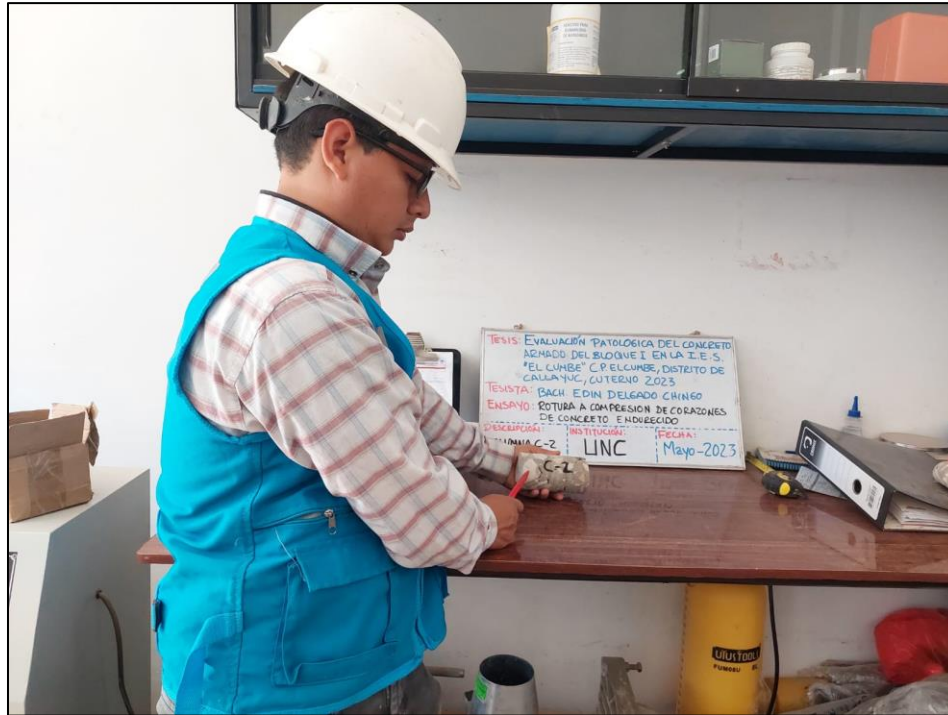
Fotografía 16: Identificación y descripción del corazón diamantino extraído de la columna.
