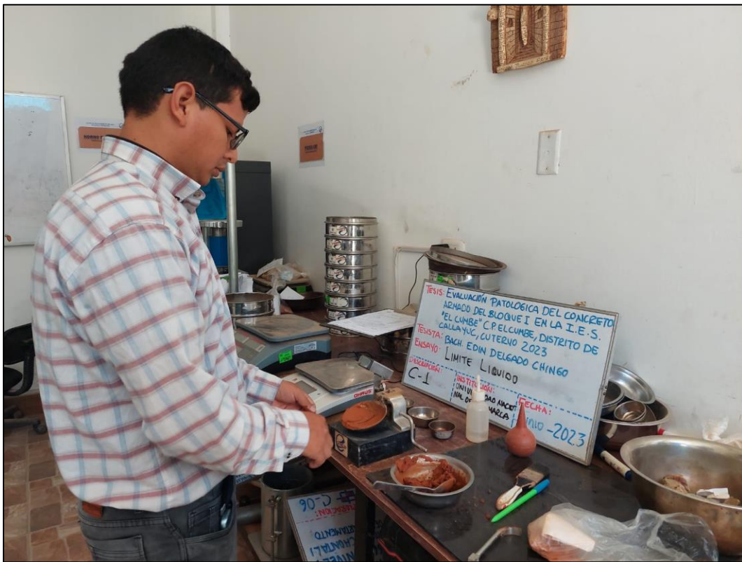
Fotografía 21: Ensayo de límite líquido de la calicata explorada.
