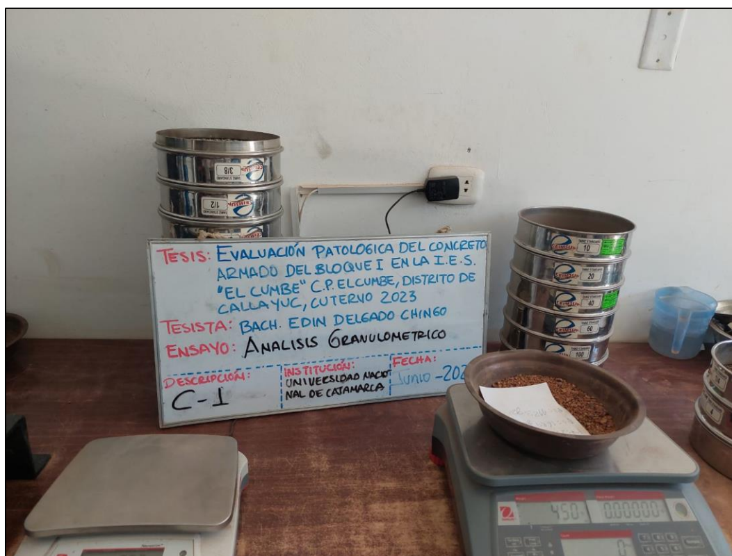
Fotografía 19: Ensayo de análisis granulométrico de la calicata explorada.
