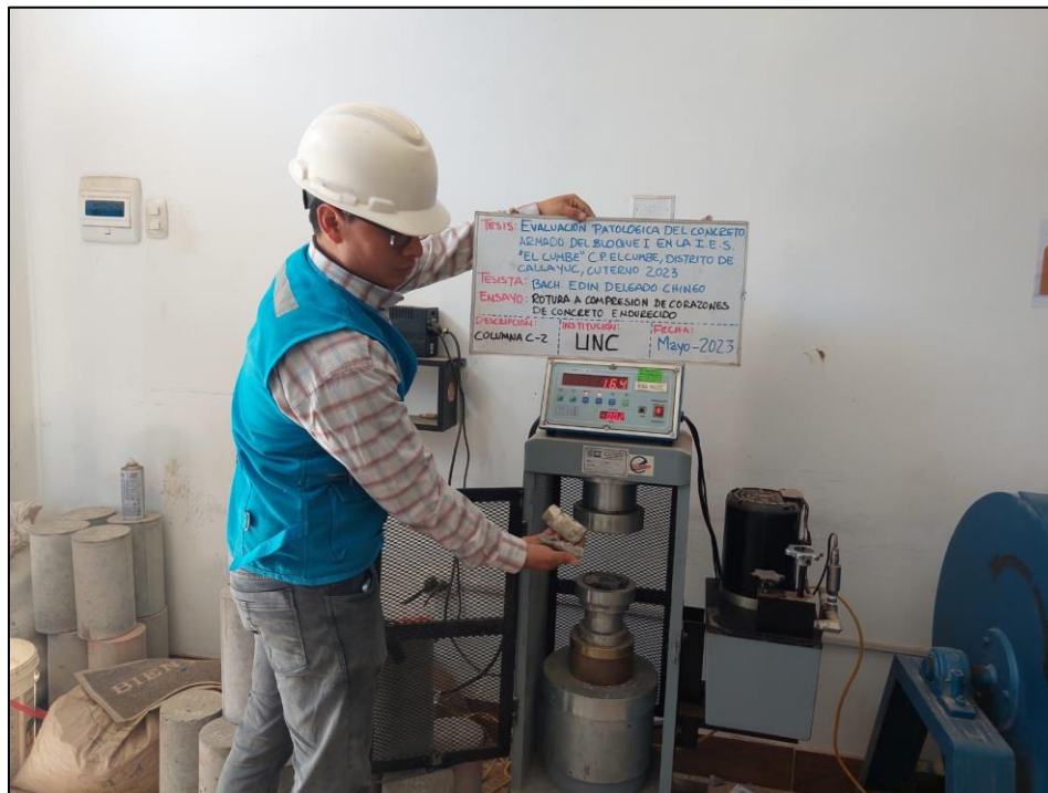
Fotografía 17: Rotura a compresión del corazón diamantino extraído de la columna.
