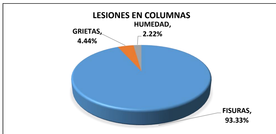
Figura 25. Total de lesiones existentes en columnas del bloque I.
