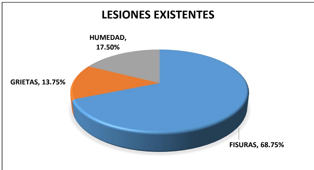
Figura 23. Total de lesiones existentes en el Bloque I de la I.E. "El Cumbe".
