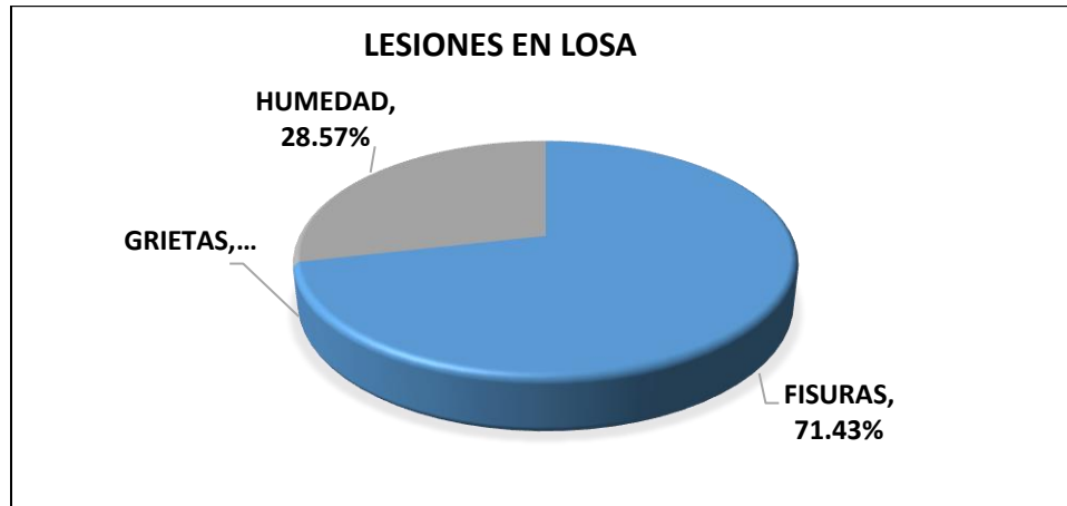
Figura 27. Total de lesiones existentes en losa aligerada del bloque I.
