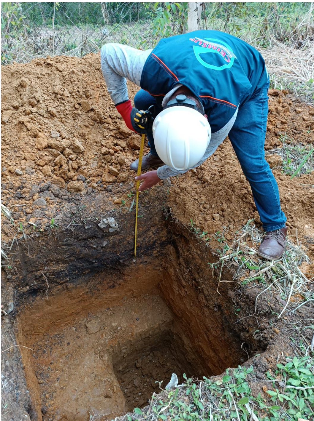
Fotografía 15: Excavación y muestreo de la calicata C-1, para la evaluación de sus características del suelo.
