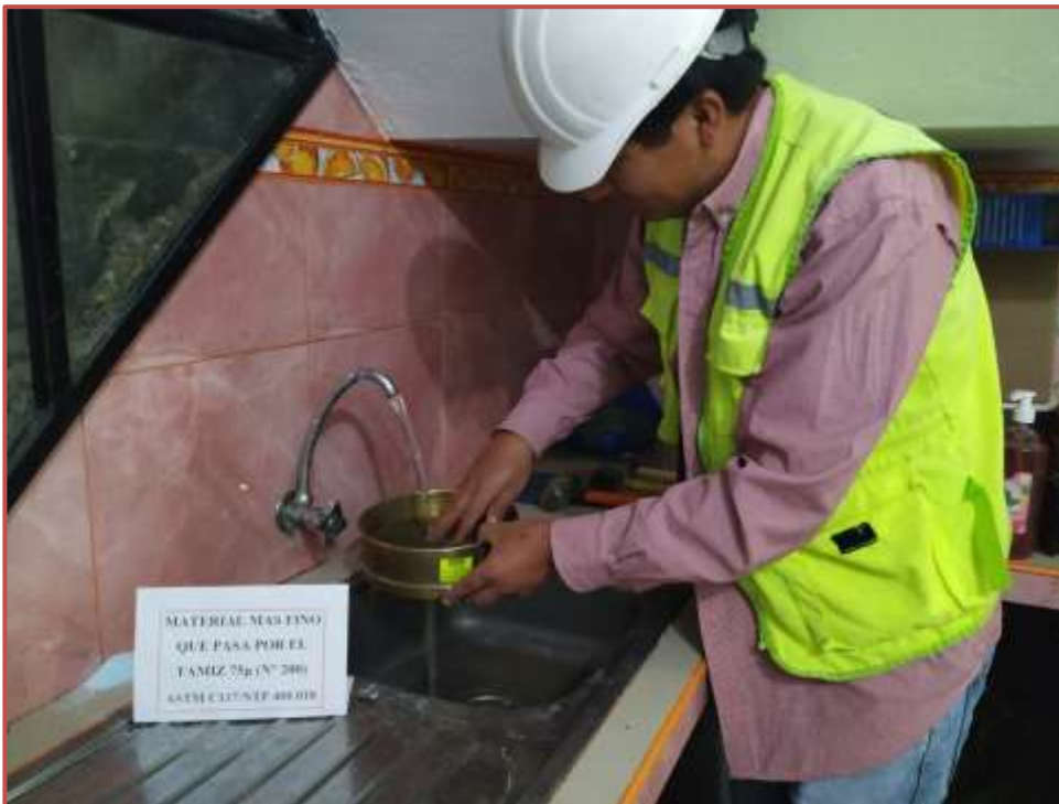
Figura 12. Ensayo para determinar el material más fino que pasa por el tamiz N° 200
