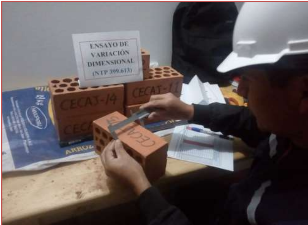
Figura 15. Ensayo de variación dimensional de cerámicos Cajamarca
