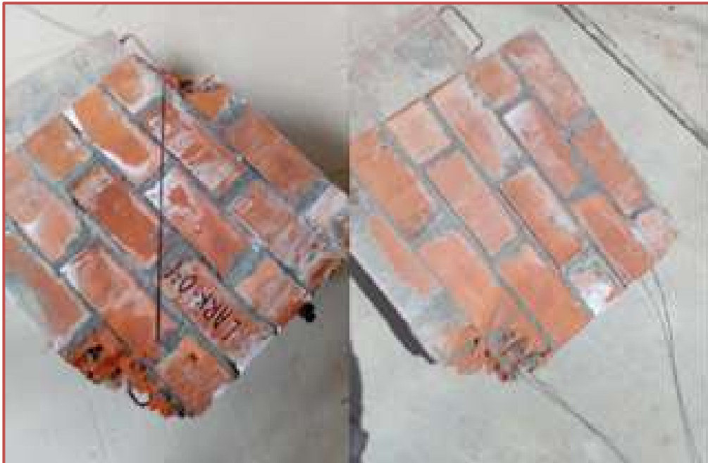
Figura 30. Falla de los muretes de cerámicos Lark
