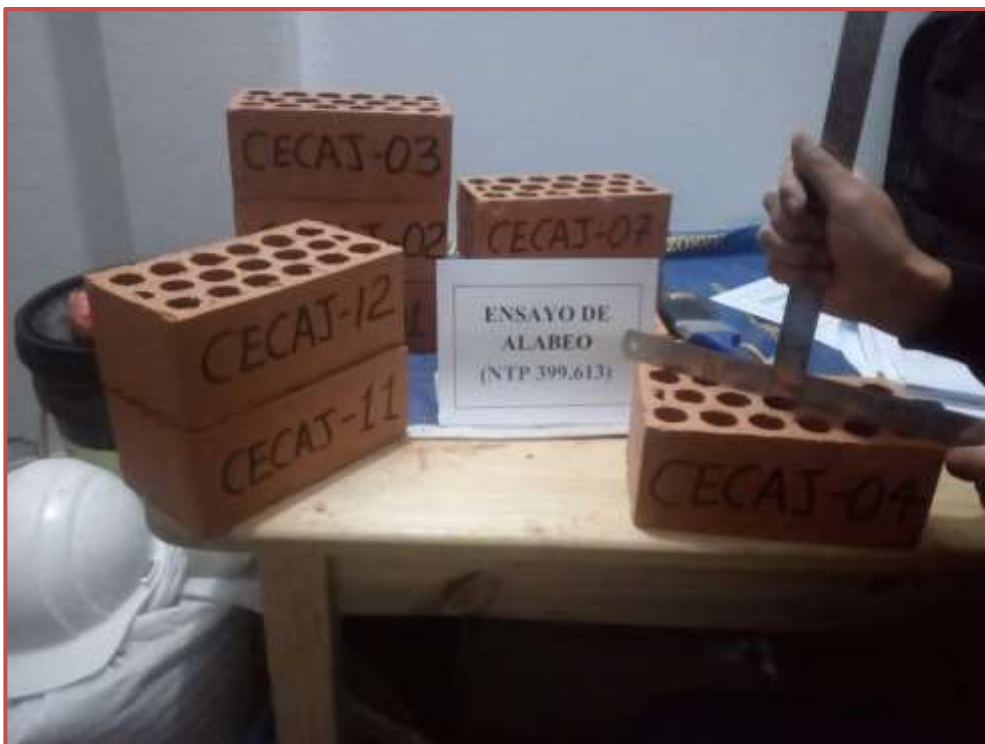
Figura 16. Ensayo de alabeo
