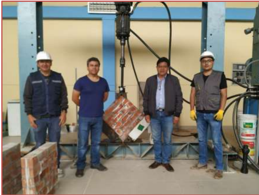
Figura 9. Ensayo de compresión diagonal en muretes de albañilería
