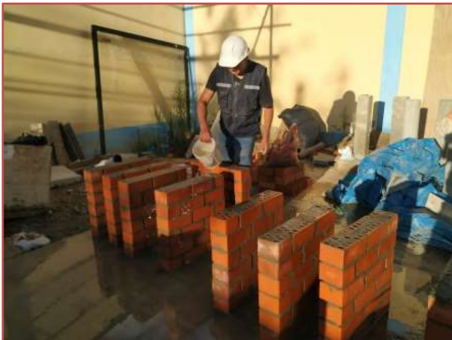
Figura 10. Curado de muretes de albañilería
