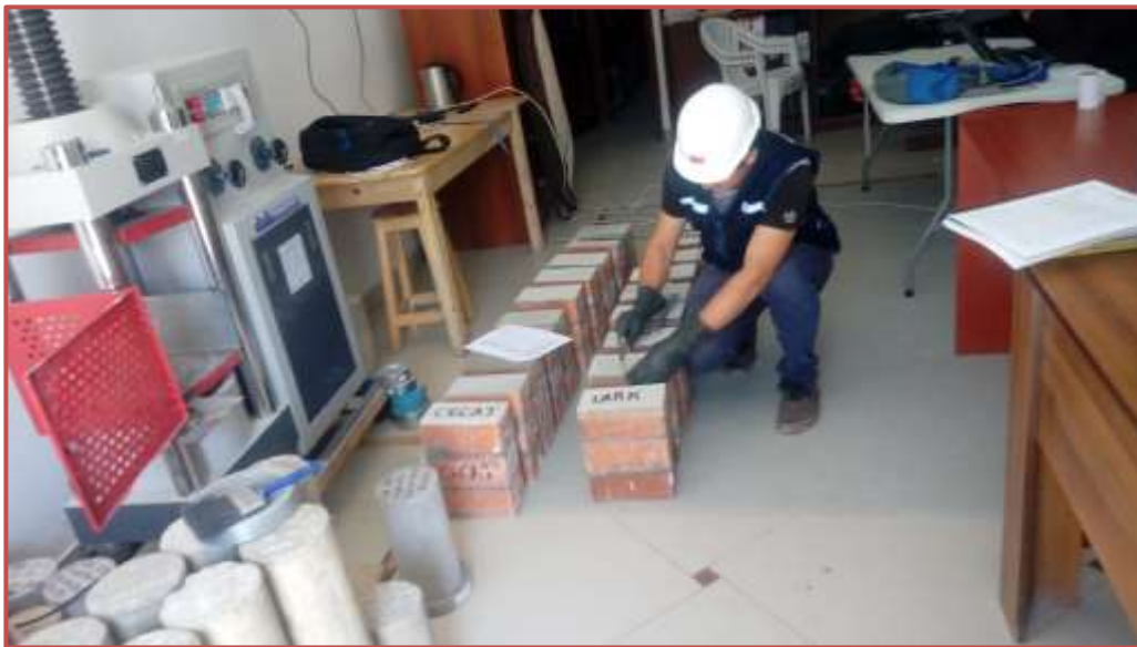
Figura 24. Registro de largo, ancho y alto de los prismas de albañilería
