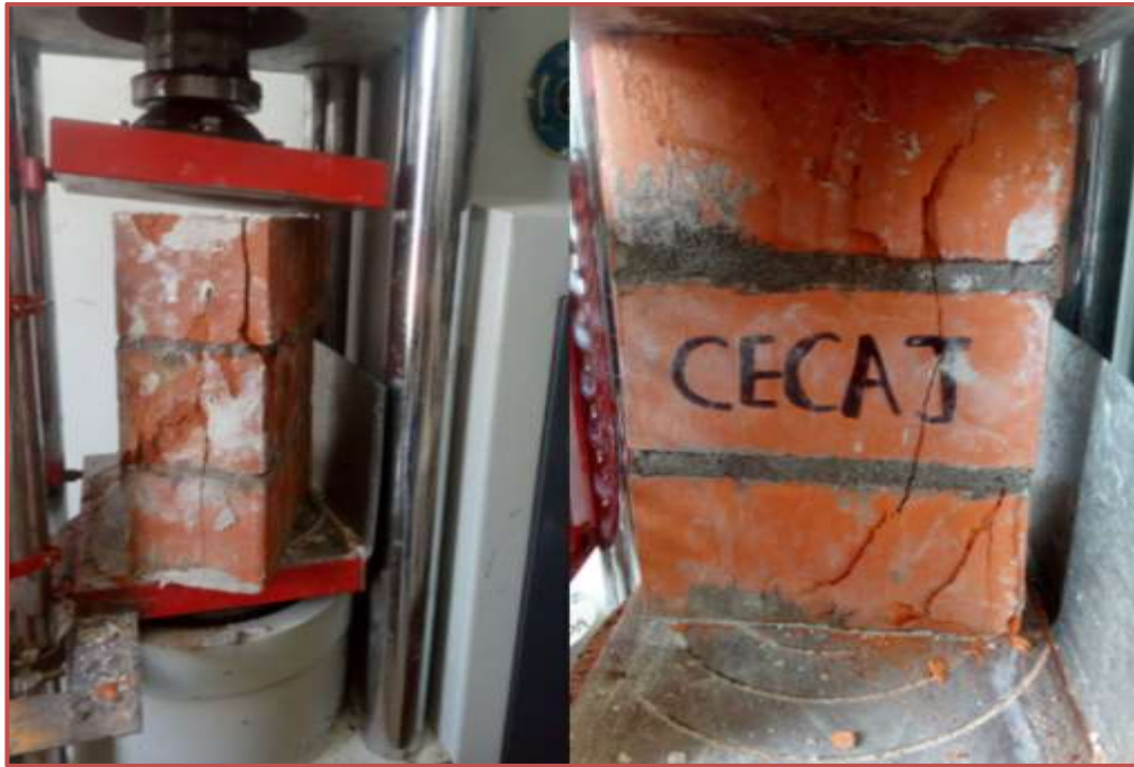
Figura 25. Ensayo de compresión axial de prismas de albañilería
