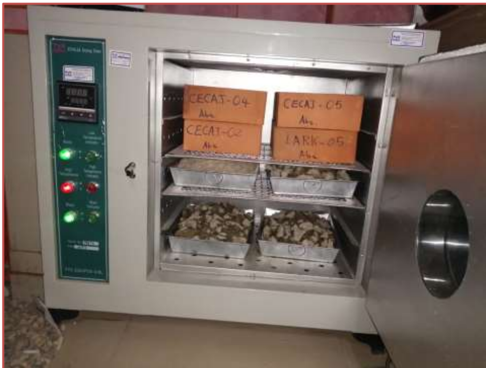
Figura 20. Secado de las unidades de albañilería para el ensayo de absorción
