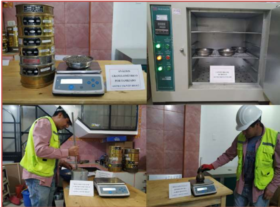
Figura 11. Ensayo de contenido de humedad, análisis granulométrico, peso unitario, peso específico y absorción del agregado fino
