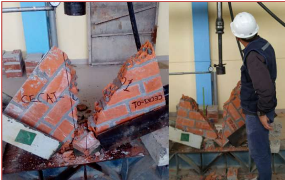
Figura 28. Falla por tensión diagonal en el murete 1, de cerámicos Cajamarca
