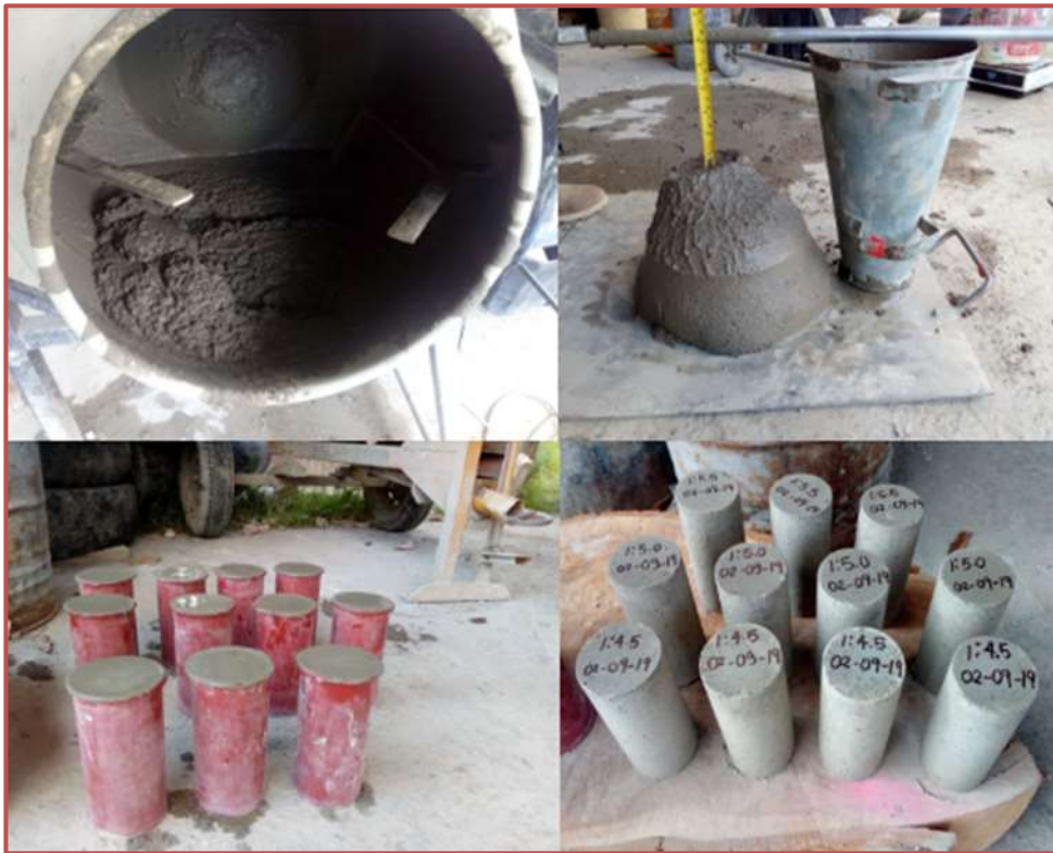
Figura 13. Mezclado, ensayo de Slump y elaboración de especímenes de mortero
