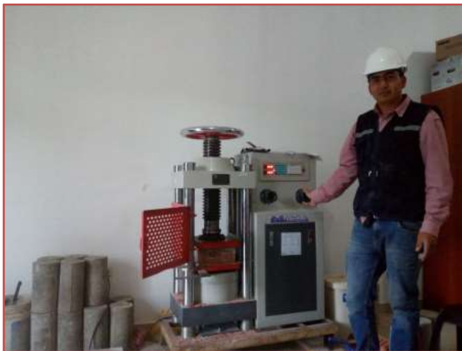
Figura 18. Ensayo de compresión simple de unidades de albañilería
