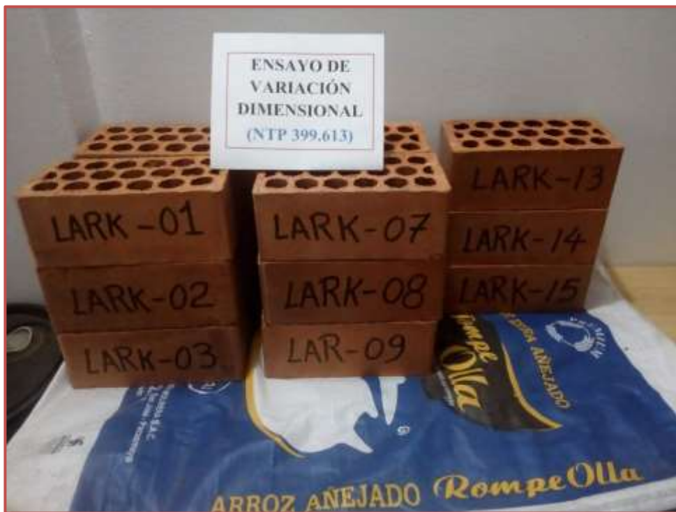
Figura 14. Ensayo de variación dimensional de cerámicos Lark
