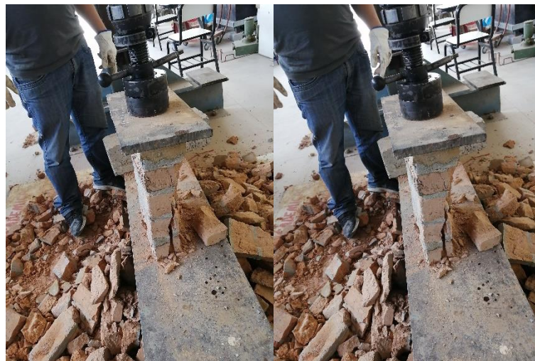
Ensayo a la compresión de pila de 5 hiladas
