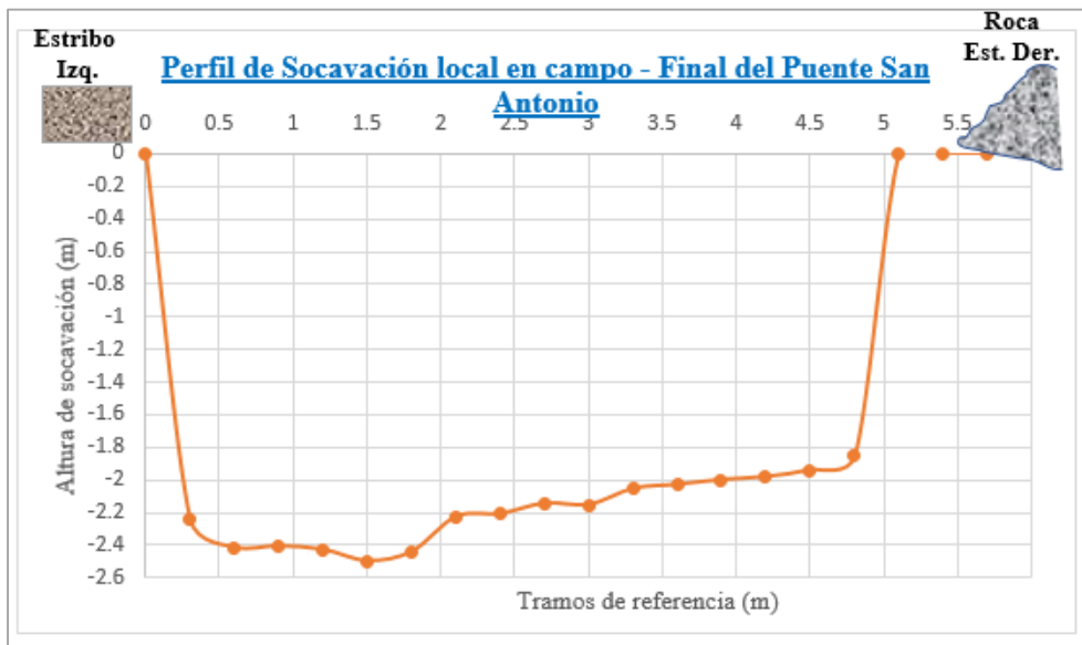
Figura 102. Perfil de socavación local en campo– Aguas abajo del eje del Puente San Antonio.
