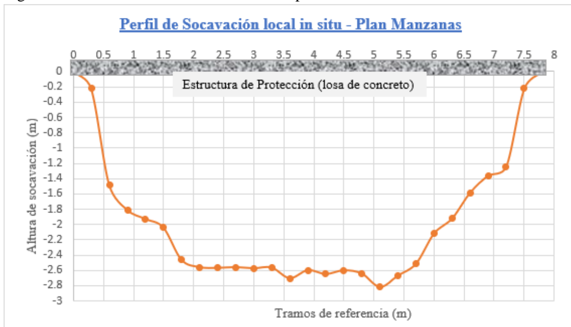
Figura 99. Perfil de socavación local en campo– Puente Plan Manzanas.
