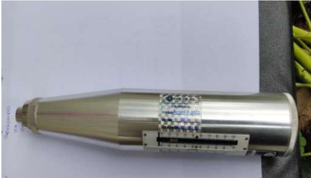
**Fotografía N° 16.** Esclerómetro usado para los ensayos.
