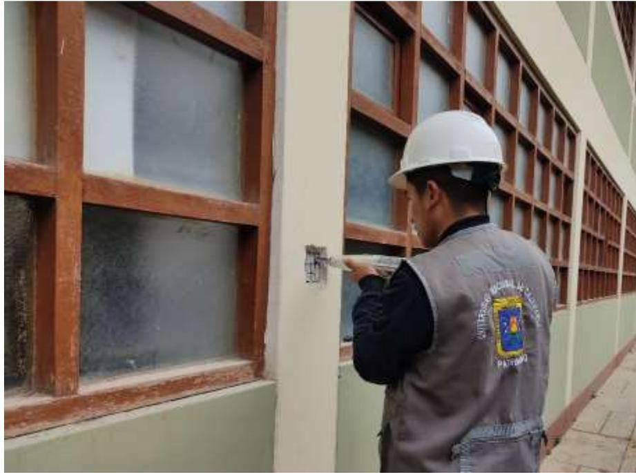
**Fotografía N° 18.** Posición del esclerómetro para realizar el ensayo de esclerometría.
