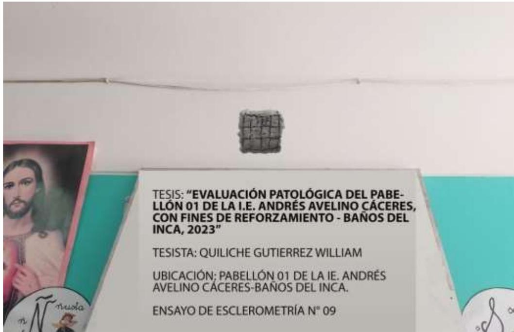
**Fotografía N° 24.** Ensayo de esclerometría en una de las losas del primer piso.
