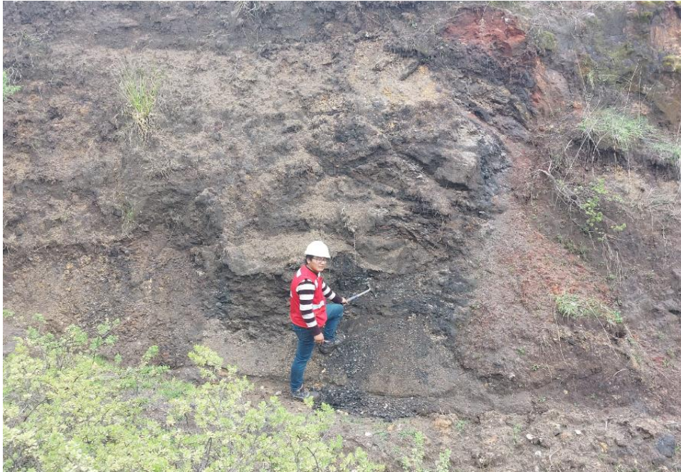
Foto 1: Punto de muestra obtenida de uno de los afloramientos de Mn mediante el método de canales, consta de realizar el muestreo en base a un canal de mineralización
