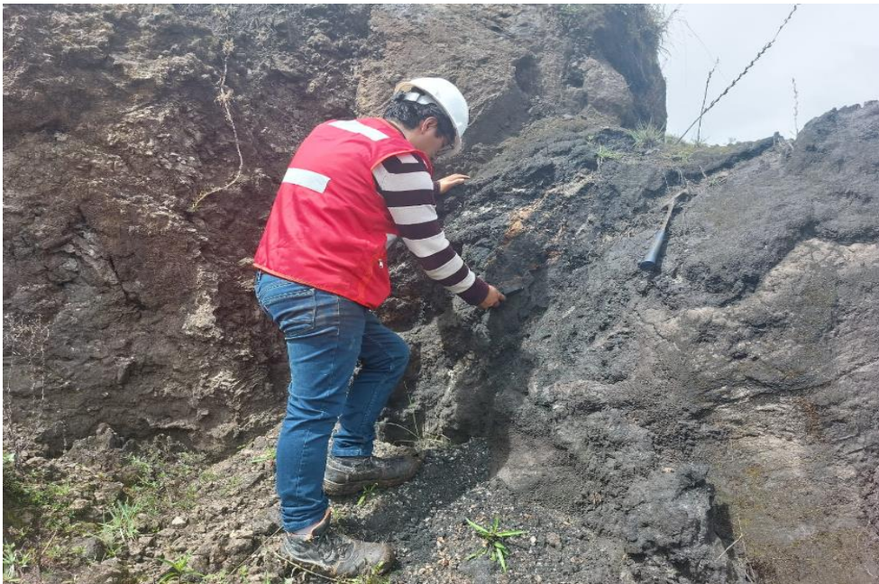
Foto 2: Punto de muestreo obtenida de uno de los afloramientos de Mn mediante el método de puntos o rock chips, consta de realizar el muestreo en diferentes puntos de mineralización
