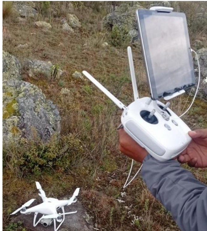
Foto 4: Levantamiento topográfico utilizando dron modelo PHANTHOM 4 PRO
