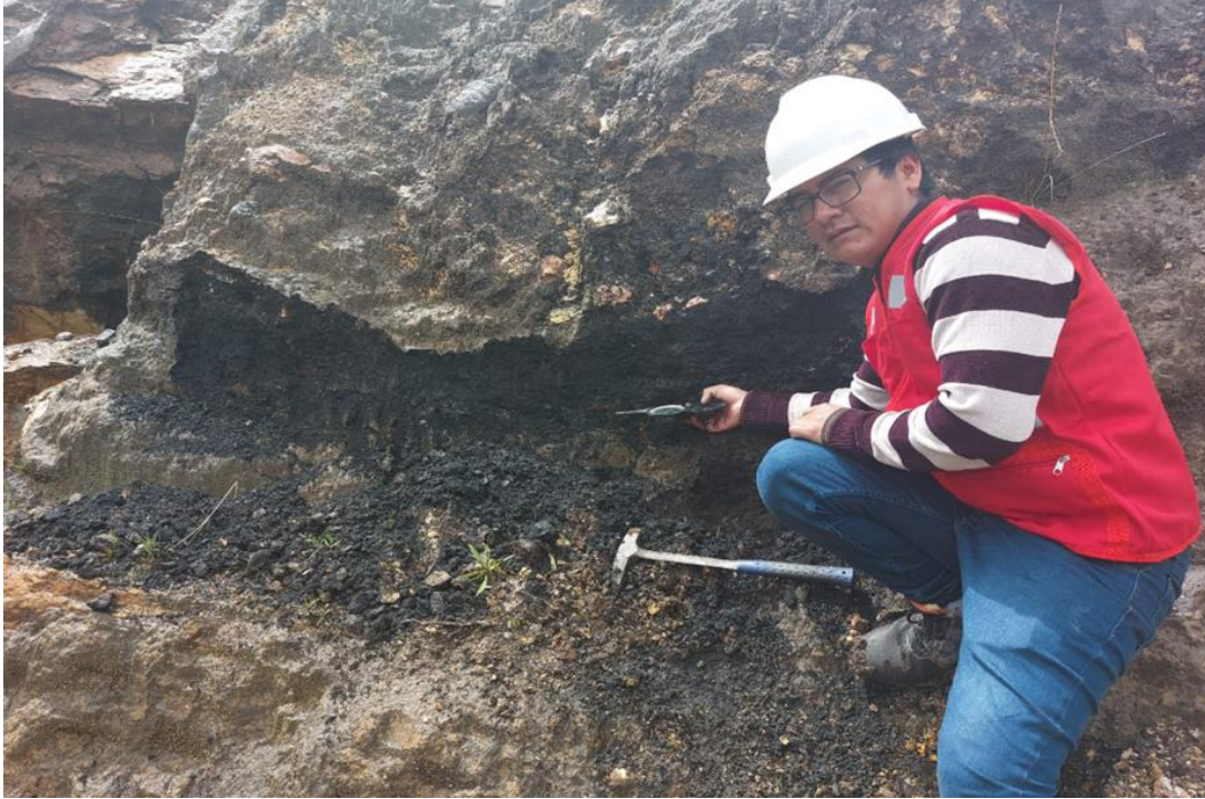
Foto 3: Sección tomando rumbo y buzamiento para poder realizar el cálculo de reservas mediante el método de secciones
