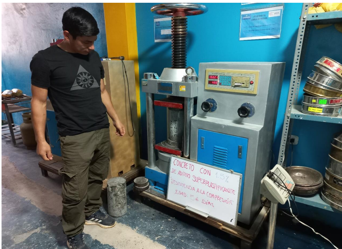
Imagen N° 22: Determinación de la resistencia a la compresión del concreto CS1.5, a los 56 días.
