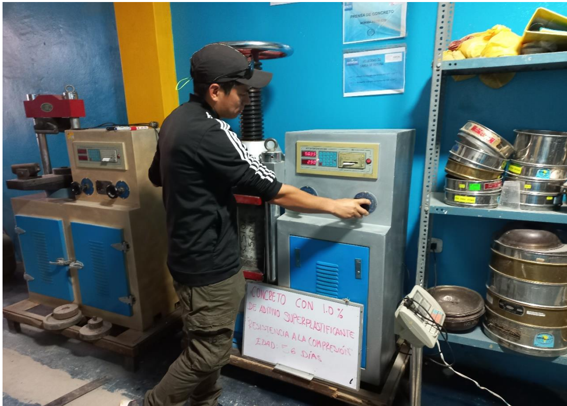
Imagen N° 21: Determinación de la resistencia a la compresión del concreto CS1.0, a los 56 días.
