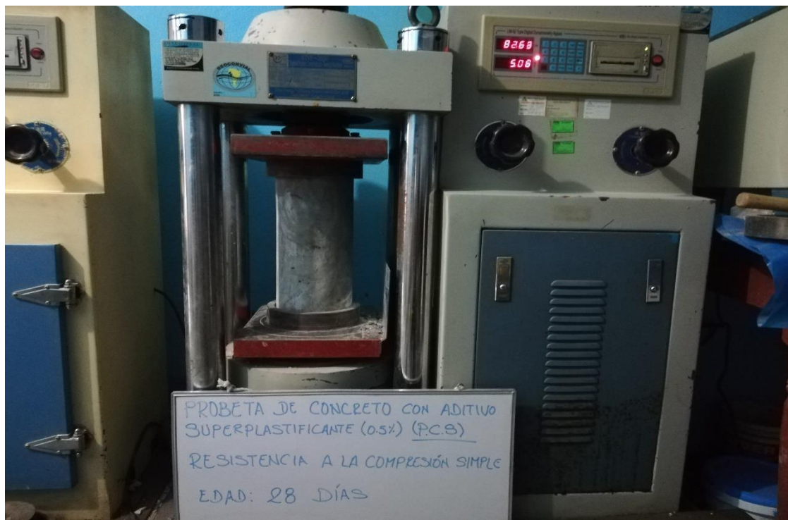
Imagen N° 14: Determinación de la resistencia a la compresión del concreto CS0.5, a los 28 días.
