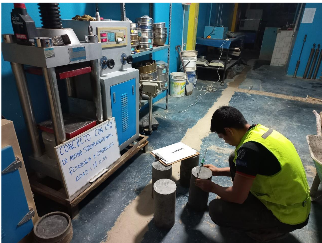
Imagen N° 18: Determinación de la resistencia a la compresión del concreto CS1.5, a los 14 días.
