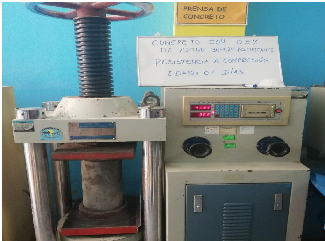
Imagen N° 11: Determinación de la resistencia a la compresión del concreto CS0.5, a los 7 días.
