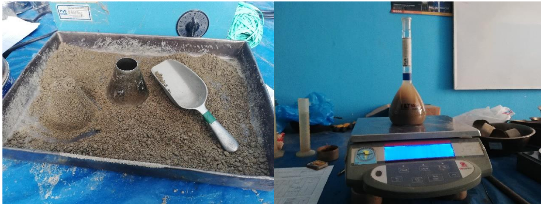
Imagen N° 1: Ensayo Peso Específico del Agregado Fino.
