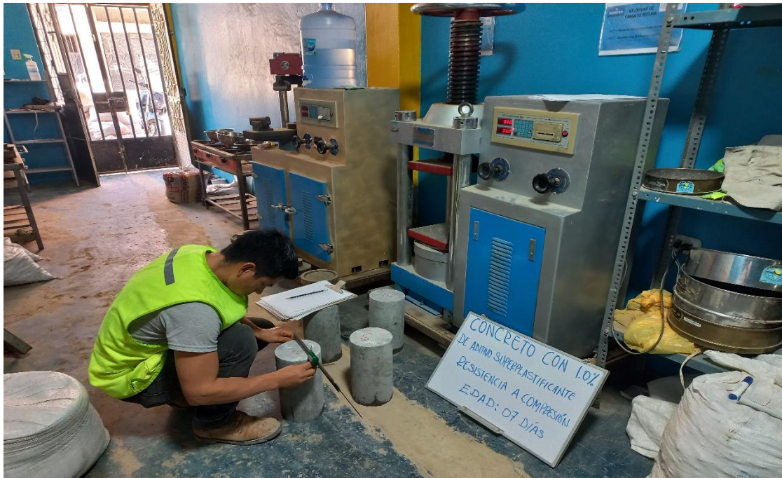
Imagen N° 15: Determinación de la resistencia a la compresión del concreto CS01.0, a los 7 días.
