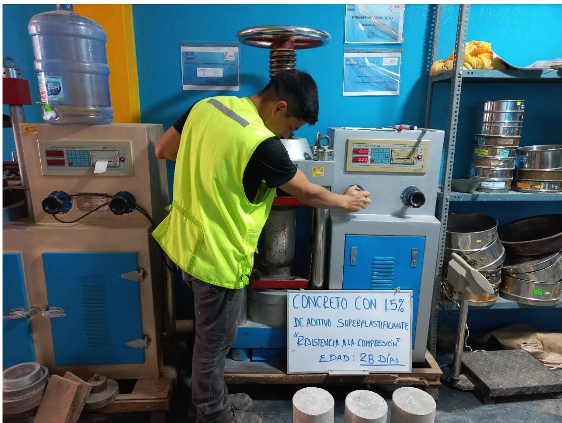
Imagen N° 20: Determinación de la resistencia a la compresión del concreto CS1.5, a los 28 días.
