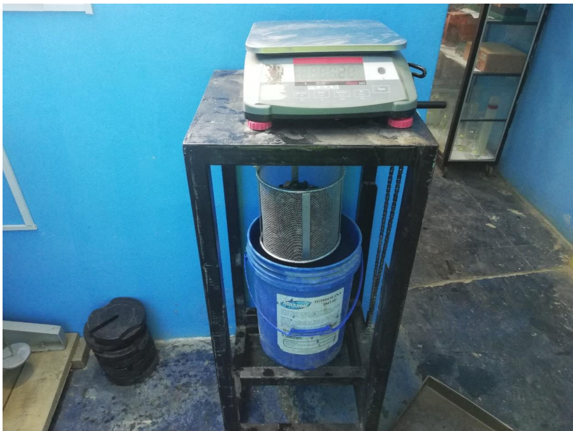
Imagen N° 2: Ensayo Peso Específico del Agregado Grueso.
