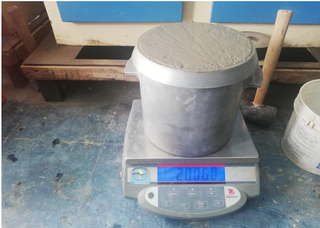
Imagen N° 5: Determinación de Peso Unitario del Concreto Fresco.
