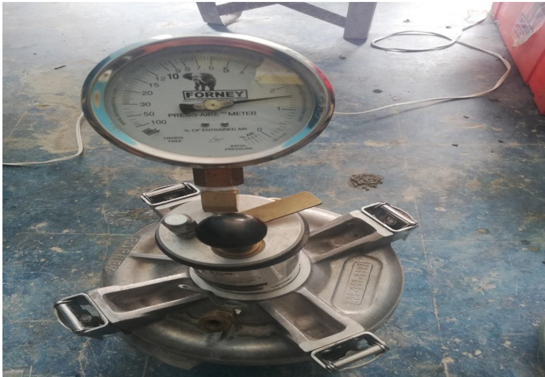
Imagen N° 7: Lectura del Contenido de Aire, en la Olla Washington.
