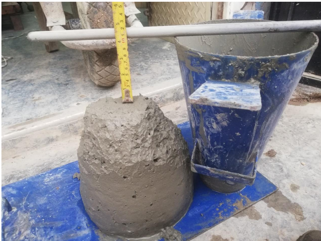
Imagen N° 10: Determinación del slump del concreto CSo.5.
