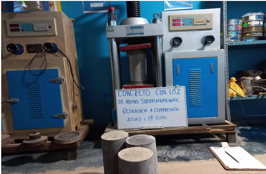
Imagen N° 17: Determinación de la resistencia a la compresión del concreto CS1.0, a los 14 días.
