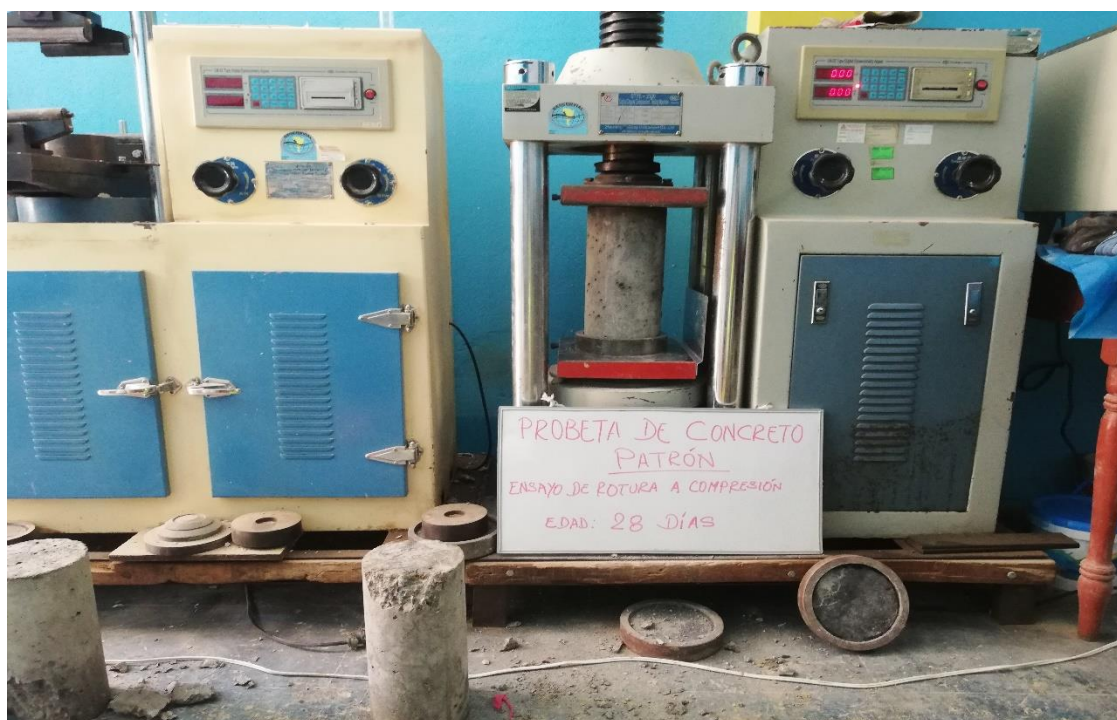
Imagen N° 12: Determinación de la resistencia a la compresión del concreto CP, a los 28 días.
