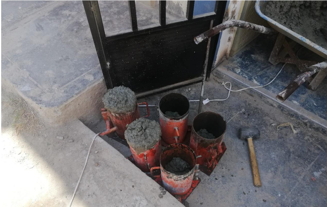
Imagen N° 9: Moldeo de Probetas de 6"x12".
