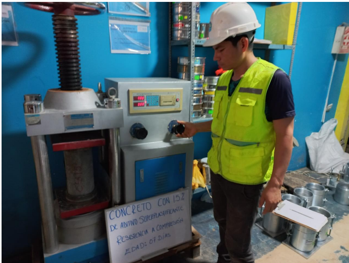
Imagen N° 16: Determinación de la resistencia a la compresión del concreto CS1.5, a los 7 días.
