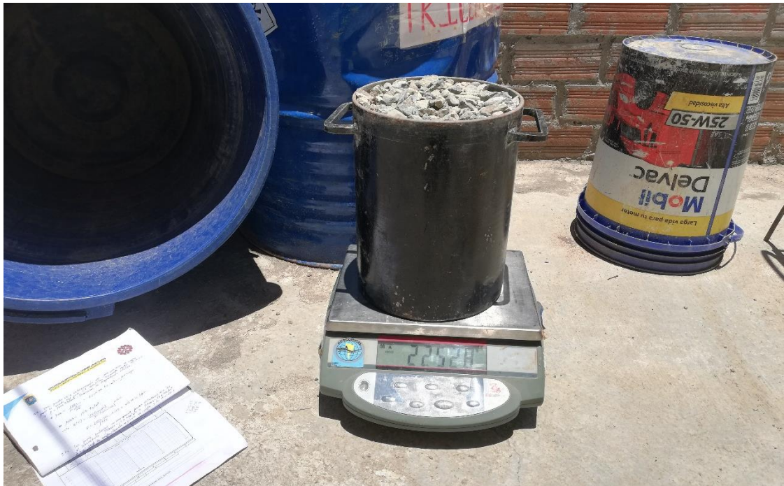
Imagen N° 3: Ensayo Peso Unitario Compactado del Agregado Grueso.
