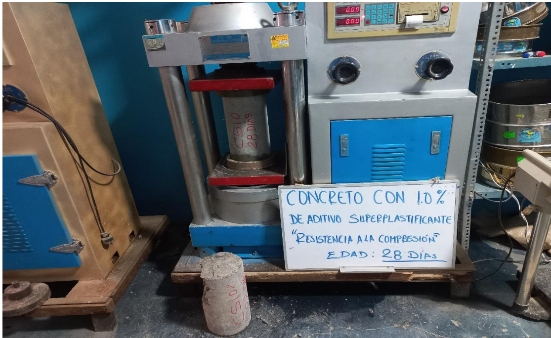
Imagen N° 19: Determinación de la resistencia a la compresión del concreto CS1.0, a los 28 días.
