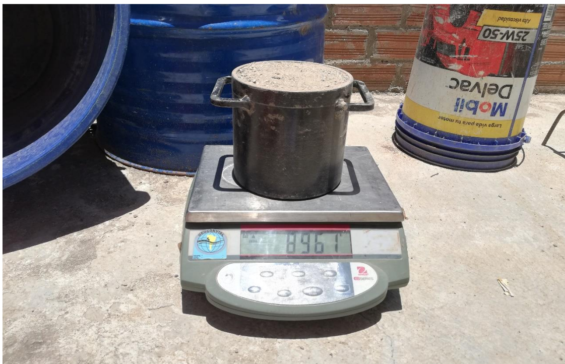
Imagen N° 4: Ensayo Peso Unitario Compactado del Agregado Fino.
