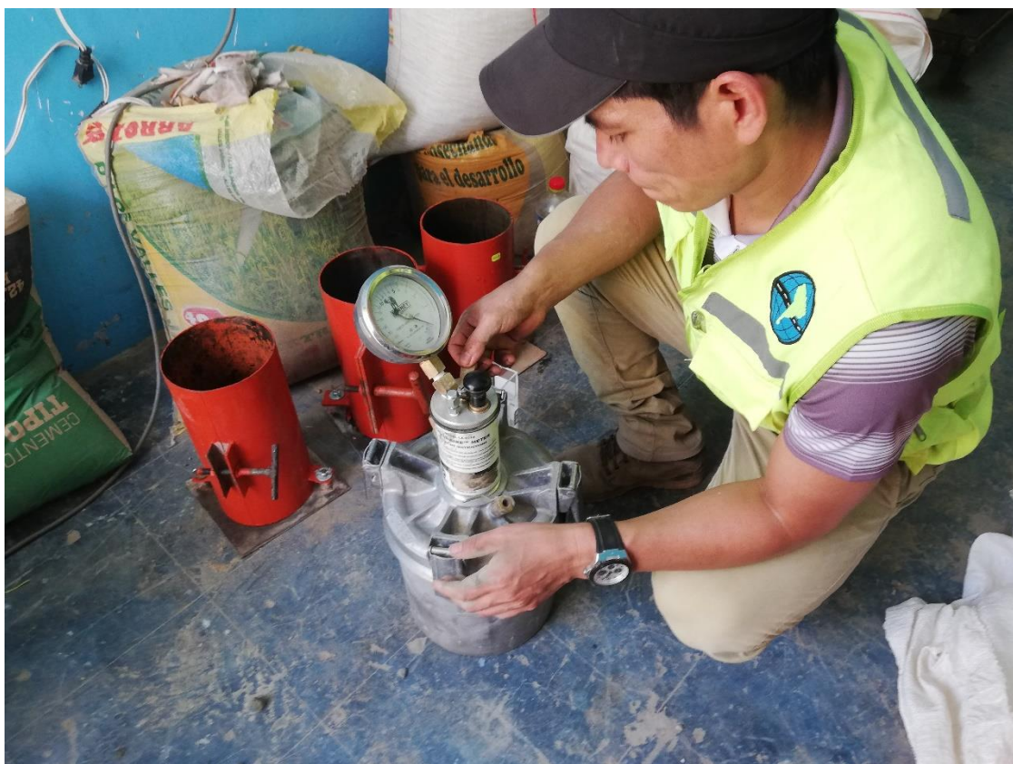
Imagen N° 6: Determinación del Contenido de Aire, con la Olla Washington.
