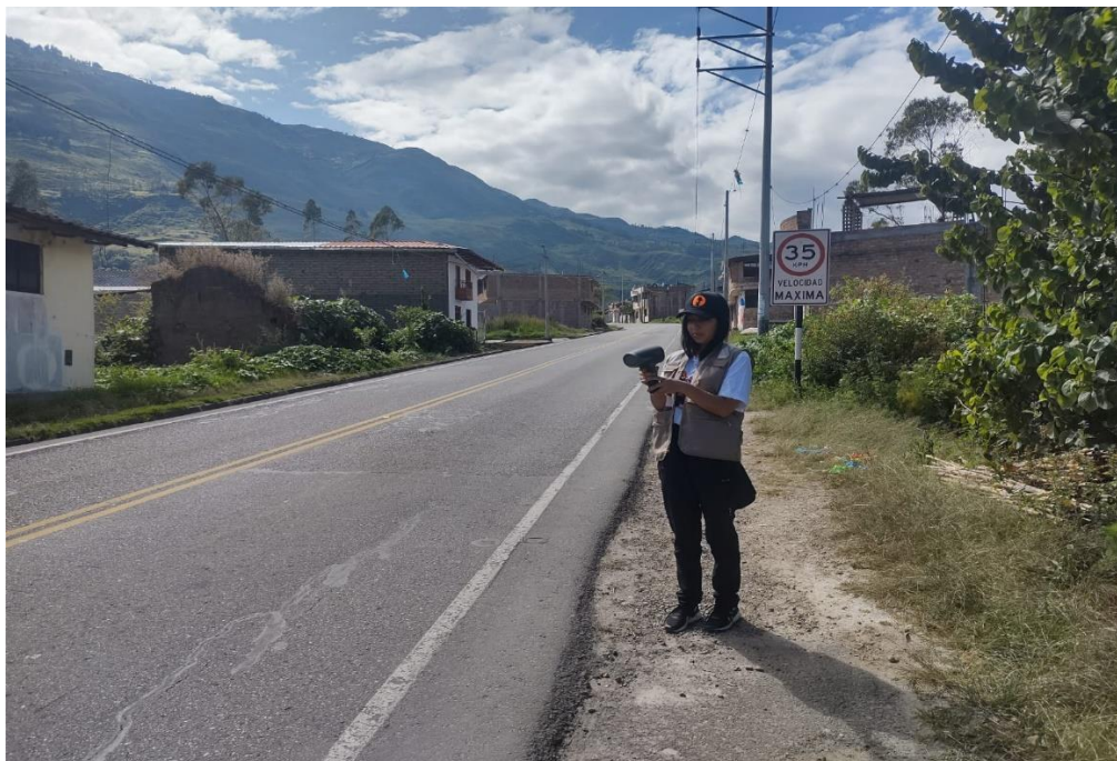
Fotografía N° 11: Toma de lectura de velocidades con la pistola radar.
