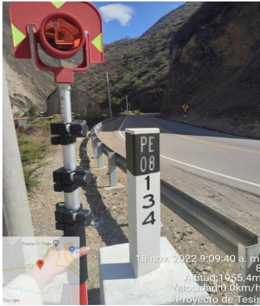
Fotografía N° 2: Prismas y bastones utilizados para el levantamiento topográfico.
