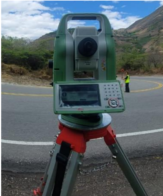
Fotografía N° 1: Estación total Leica TS – 10 serie 3304385
