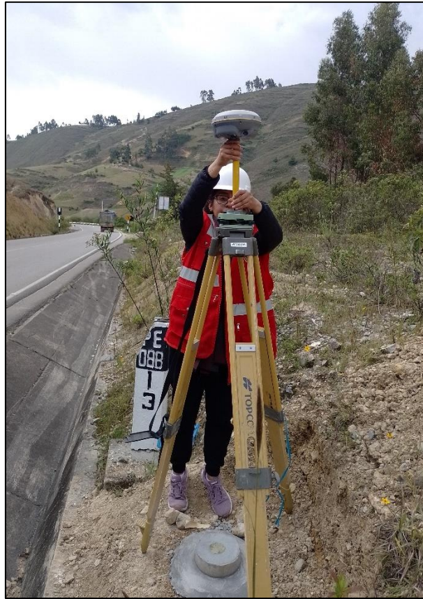
Fotografía 05: Recepción de puntos en el punto estático “PPC - B”
