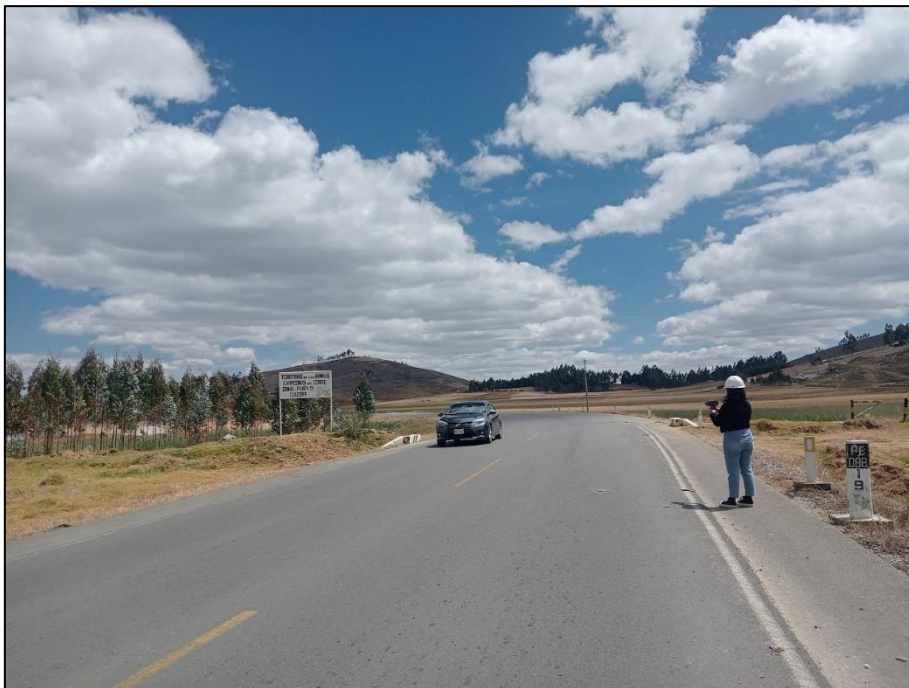
Fotografía 15: Medición de la velocidad de operación con el velocímetro a la altura del Km. 16 de la carretera Puyllucana – Pampa de La Culebra
