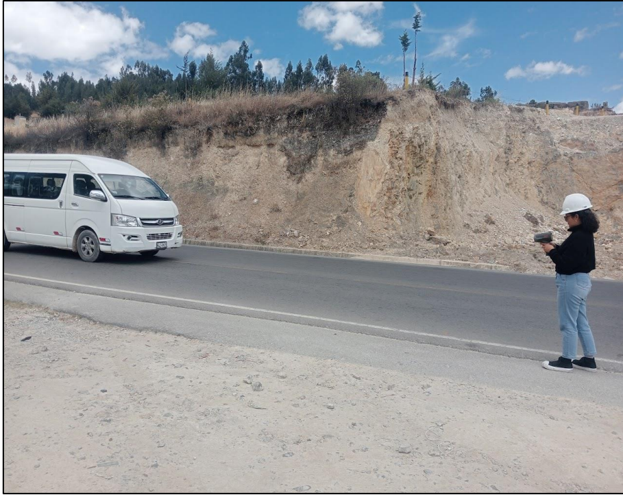
Fotografía 14: Medición de la velocidad de operación con el velocímetro a la altura del Km. 16 de la carretera Puyllucana – Pampa de La Culebra
