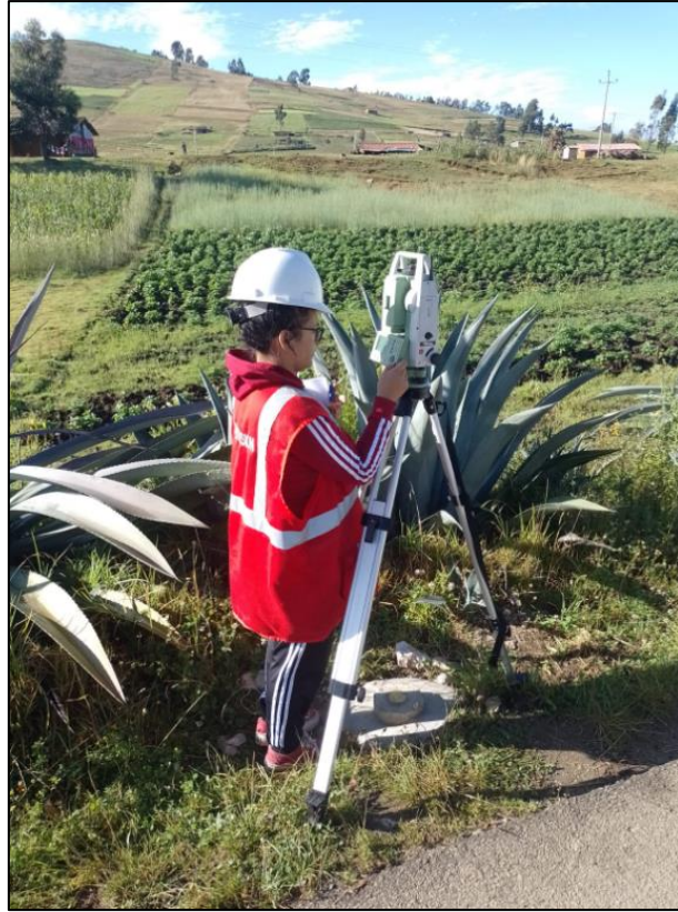
Fotografía 07: Levantamiento topográfico tomando como BM al punto estático C
