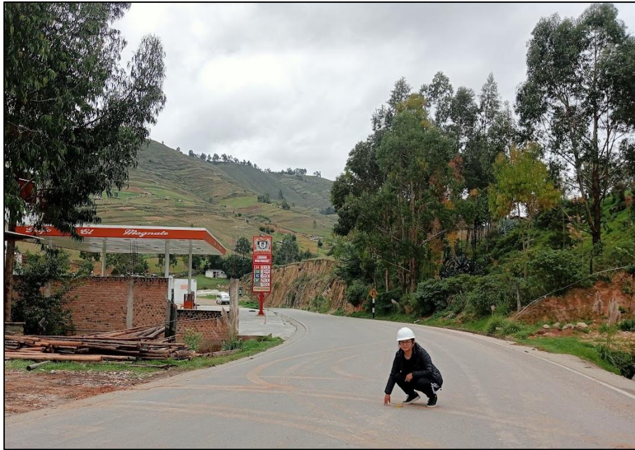
Fotografía 12: Medición de peraltes con eclímetro a la altura del Km. 12 de la carretera Puyllucana – Pampa de La Culebra.
