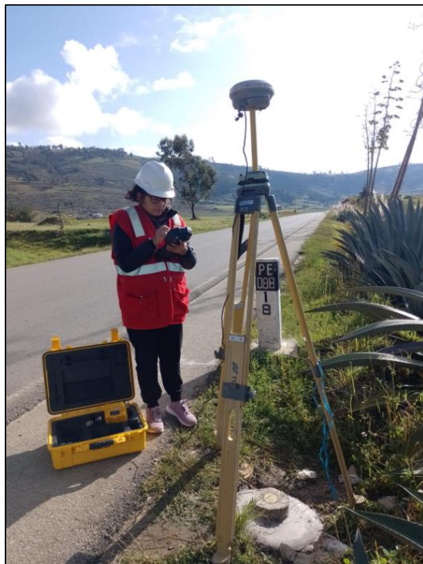
Fotografía 04: Recepción de puntos en el punto estático “PPC - C”
