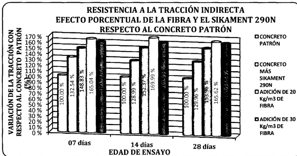
**Gráfico N° 13:** Variación porcentual de la resistencia a tracción indirecta producida por la fibra de acero y el Sikament 290N respecto al concreto patrón.
