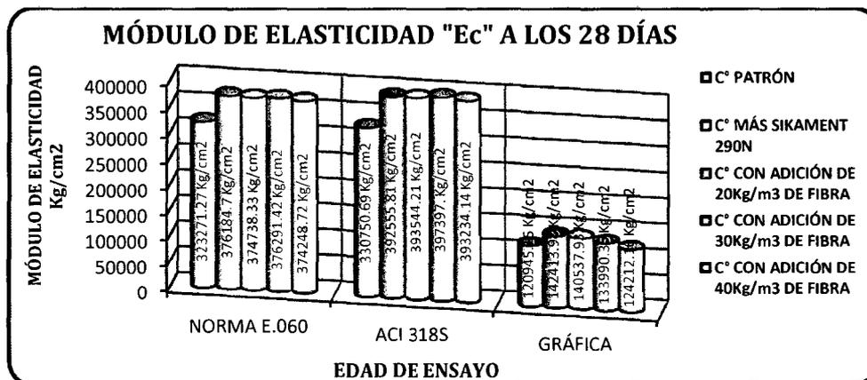
**Gráfico N° 20:** Módulos de elasticidad de los diferentes tipos de concreto evaluados, según normas E.060, ACI 318S, y gráfica esfuerzo Vs. Deformación, a 28 días de edad.
