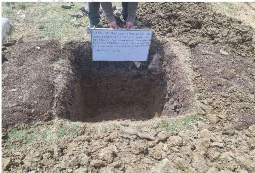
FOTOGRAFÍA N° 04: Vista de perfil estratigráfico de la calicata C-2.
