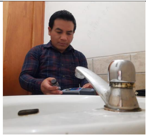
Fotografía N° 20: Toma de muestra en el extremo de la red
