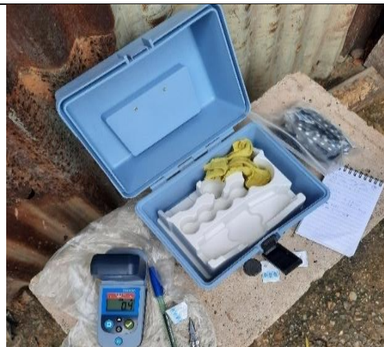
Fotografía N° 09: Clorímetro y pastillas DPD
