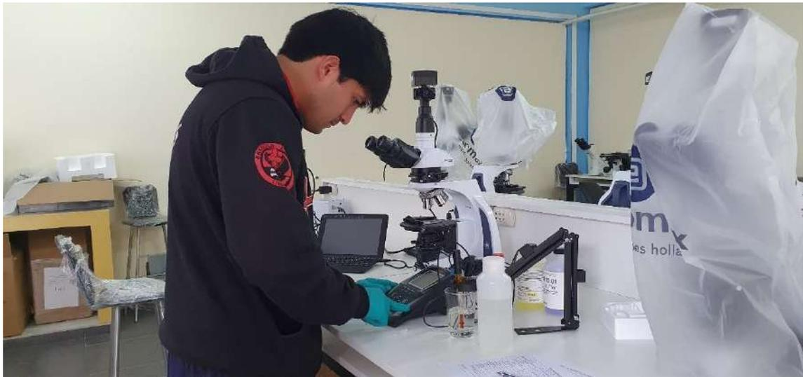
Figura 49 Medición del pH de la muestra de comprobación
