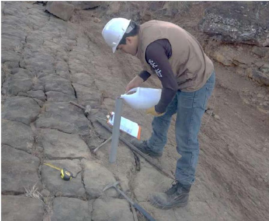
Figura 24 Procedimiento del ensayo de infiltración 02
