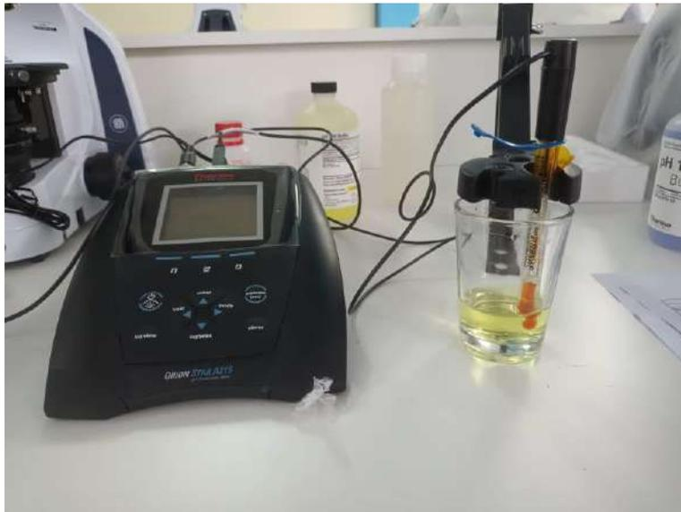
Figura 46 Calibración con la solución buffer de pH 7
