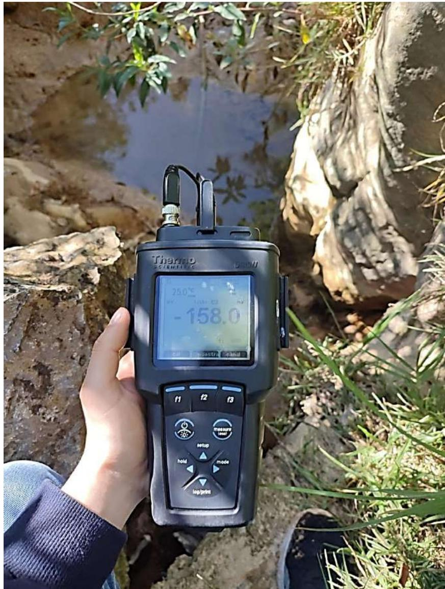
Figura 29 Medición del pH y otros parámetros fisicoquímicos In Situ, con multiparametro portátil Thermorion En el primer punto de muestreo (E:790420; N:9200841)
