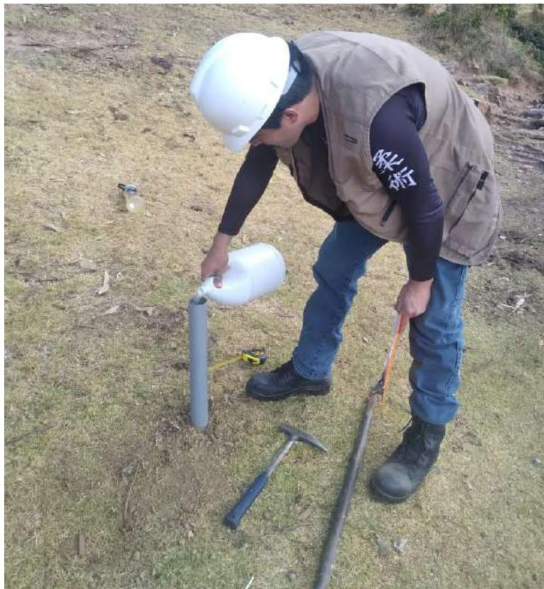
Figura 22 Procedimiento del ensayo de infiltración 01
