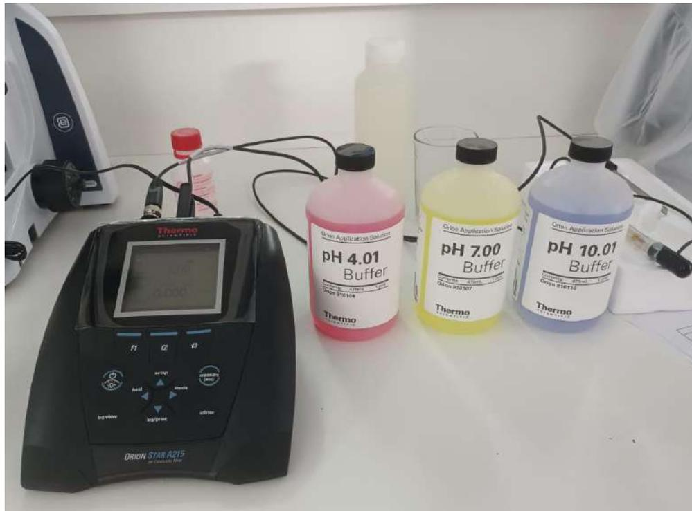
Figura 45 Soluciones Buffer para la calibración del multiparametro
