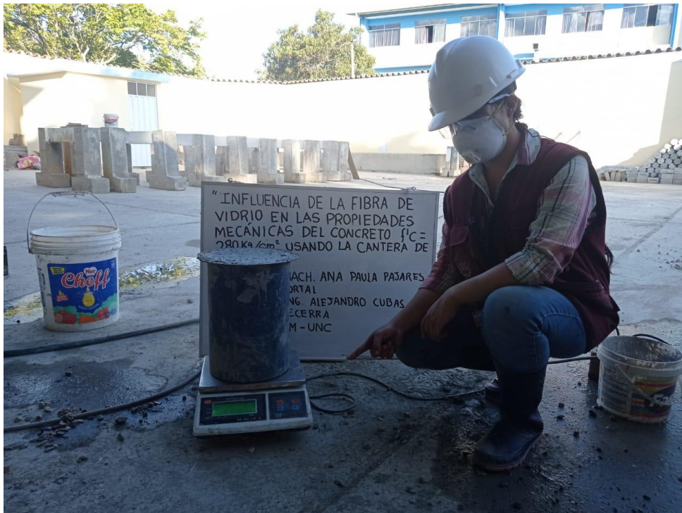
Figura 20: Determinación del peso unitario del concreto en estado fresco
