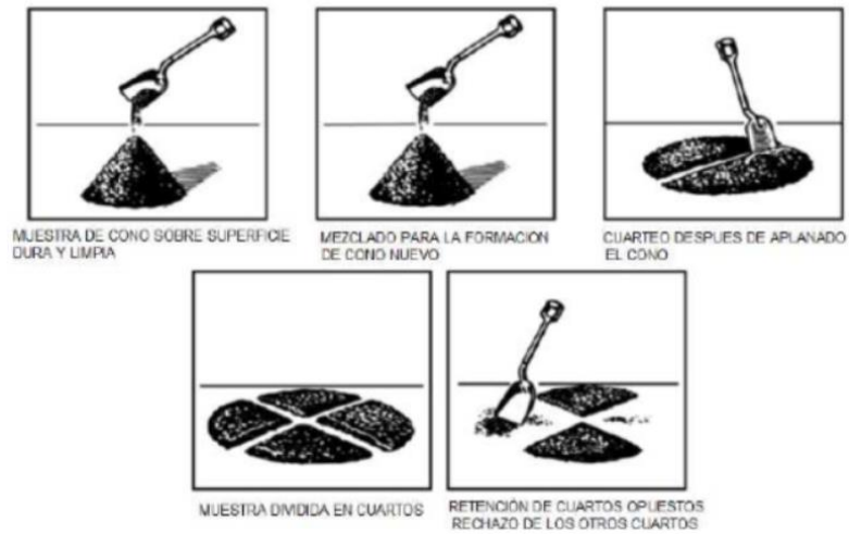
Figura 1: Cuarteo sobre una superficie dura, nivelada y limpia
