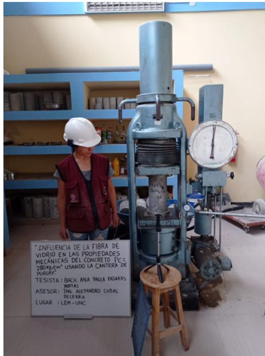
Figura 22: Ensayo de resistencia a compresión de los especímenes de concreto cilíndricos
