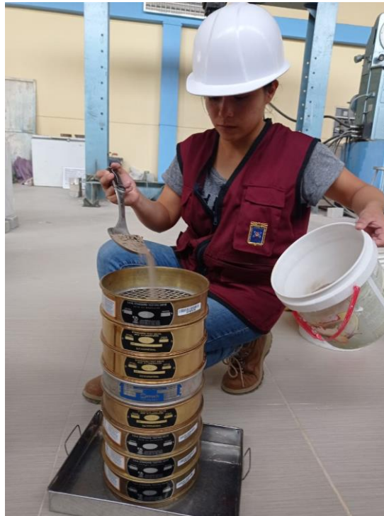
Figura 16: Ensayo de análisis granulométrico
