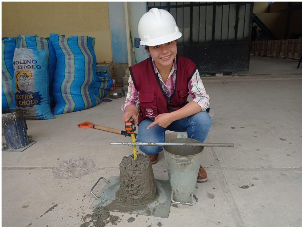
Figura 19: Ensayo de revenimiento o asentamiento de concreto en el cono de Abrams
