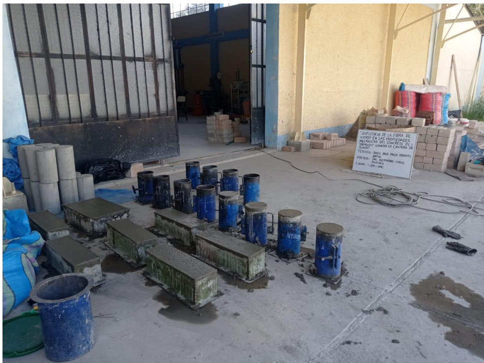
Figura 21: Elaboración de los especímenes de concreto cilíndricos y prismáticos
