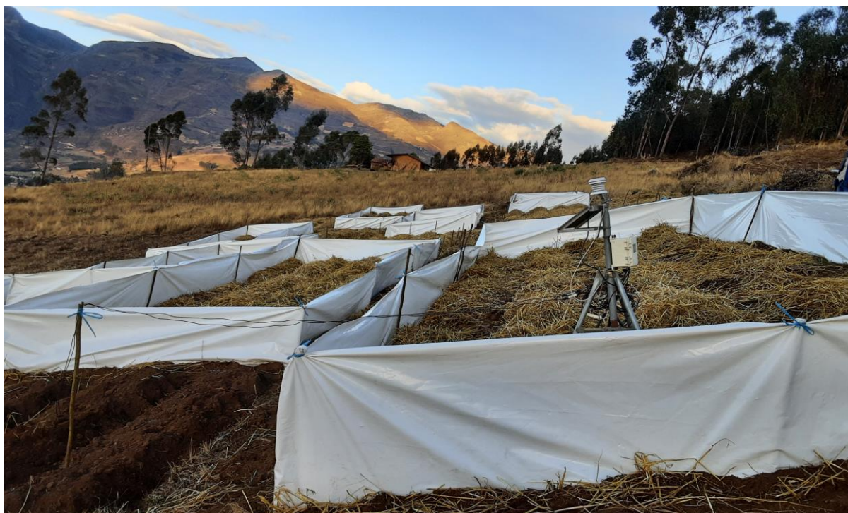
Foto 3: Instalación de la estación Hobo con sensores de temperatura de suelo en el tratamiento testigo_T0 (labranza y manejo convencional) y tratamiento T9 (labranza cero con 30 cm de espesor de “mulch”), 10 de octubre 2022.
