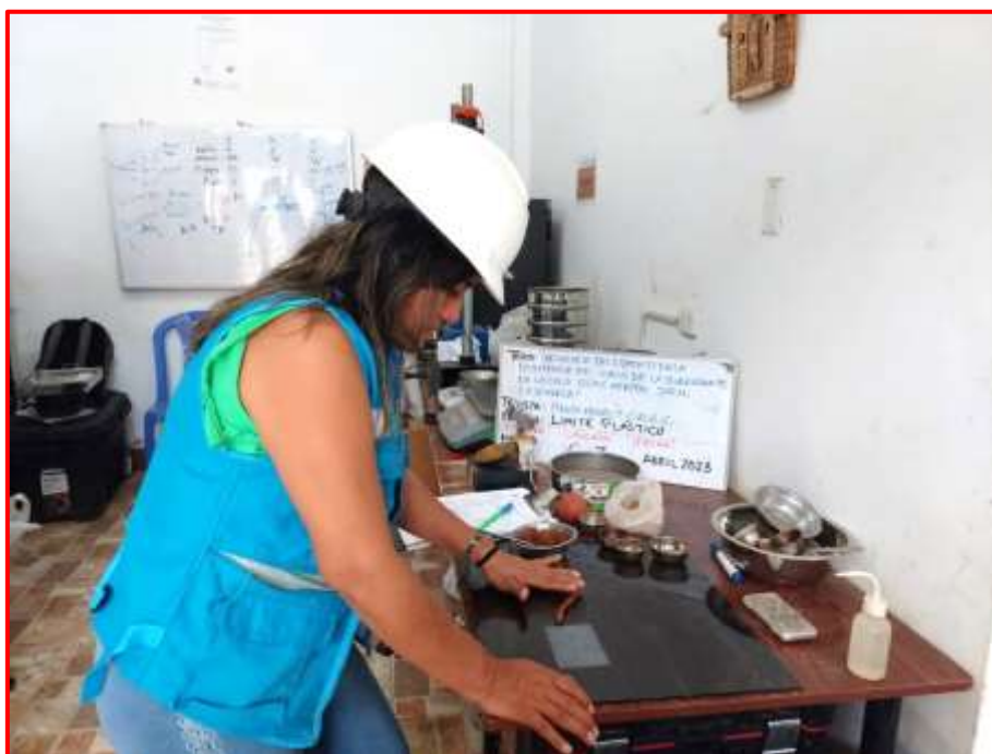
Figura 78. Determinación del Límite plástico, muestra C3-IP-2%.
