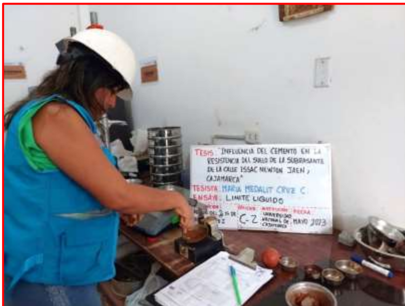
Figura 77. Determinación del Límite Líquido, muestra C2-IP-2%.
