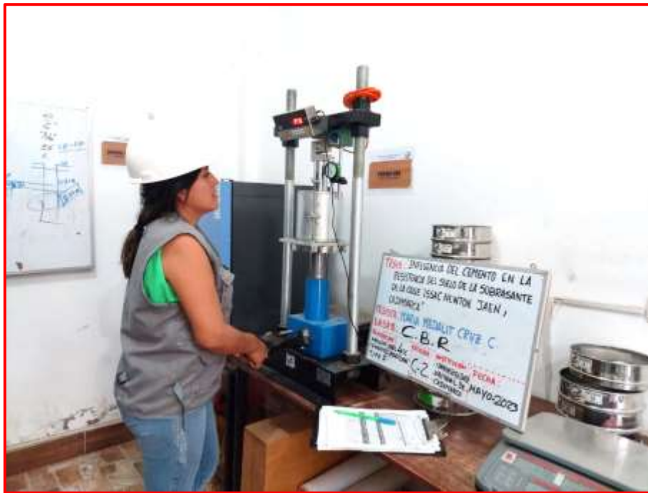
Figura 80. Ensayo de CBR al 2% para la muestra C-3.
