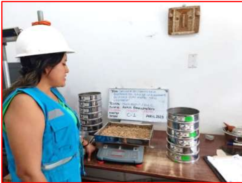
Figura 76. Análisis granulométrico, tamizado. Muestra C-1
