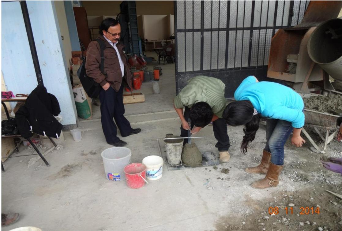
**VERIFICACIÓN DEL SLUMP DEL DISEÑO DE MEZCLAS EN PRESENCIA DEL ING. HECTOR PEREZ LOAYZA (Asesor de tesis)**
