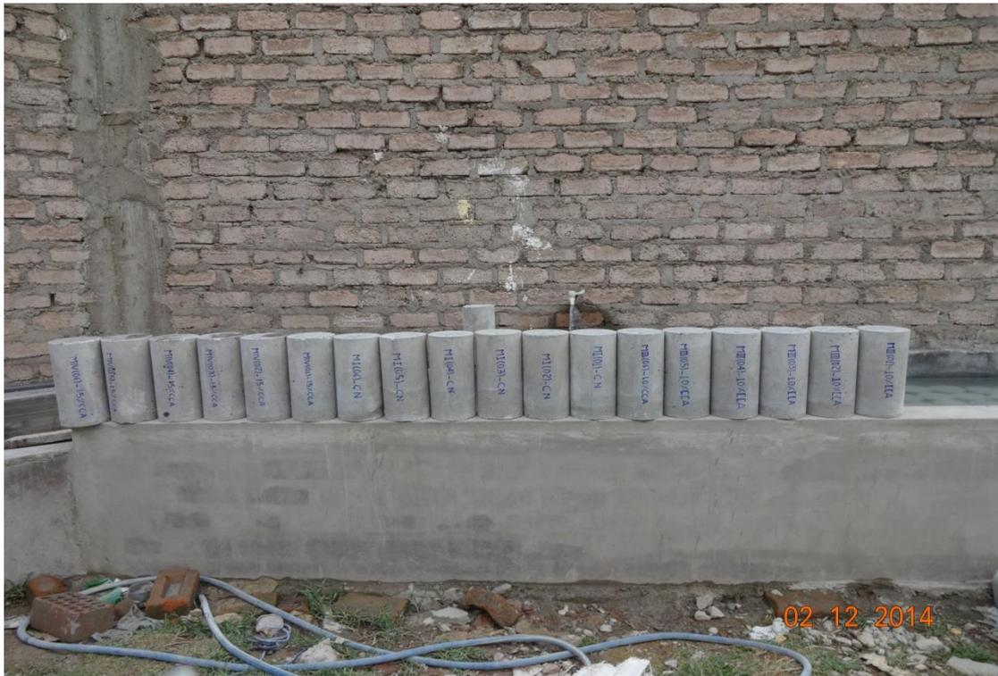
**ESPECÍMENES DE CONCRETO COMPLETAMENTE LISTAS PARA SER ENSAYADAS**
