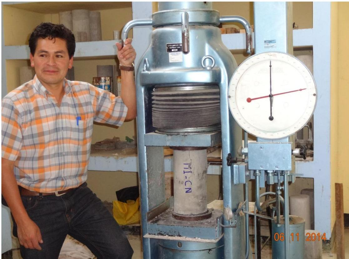
**ENSAYOS A COMPRESIÓN DE ESPECÍMENES DE CONCRETO**
