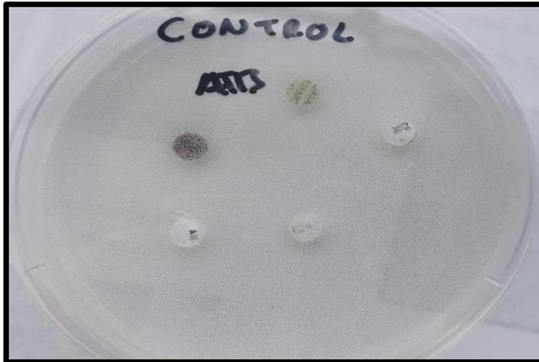
Figura 3. Placa de Petri con Agar Mueller Hinton inoculadas con *Bacillus subtilis* y discos de antibióticos (tetraciclina, gentamicina, ampicilina y sulfametoxazol con trimetoprima).
