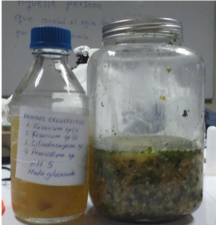
En la figura 7, se observa el biorreactor artesanal, constituido por un frasco de vidrio de 3 litros de capacidad, el cual se recargó con 500 gramos de residuos orgánicos, mezclando con 1 litro de agua destilada estéril, inmediatamente se inoculó con 50mL de un consorcio microbiano celulítico.
