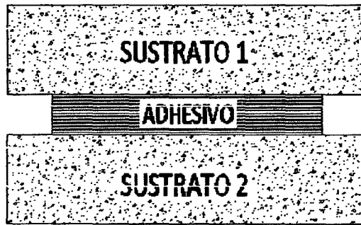
Figura 2.3. Esquema básico de la unión adhesiva
