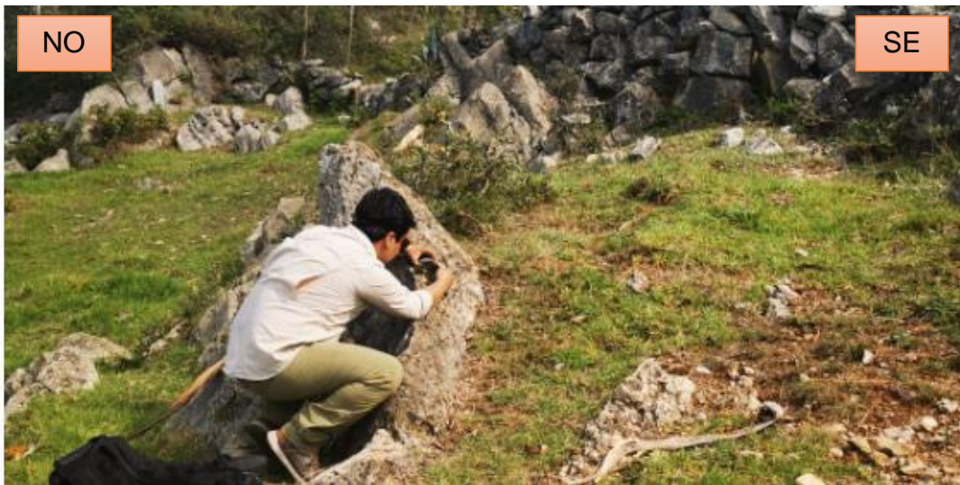
Foto 6. 2 Medición de rumbo y buzamiento de los estratos de calizas del miembro inferior.
