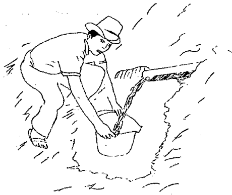
FIG. 2.11. AFORO DEL AGUA POR EL MÉTODO VOLUMÉTRICO.
