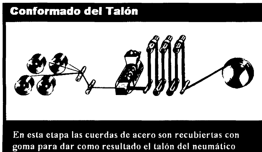
Fig. 2.8: Conformado de talón
