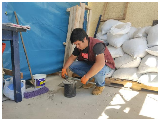
Figura 35. Ensayo para determinar el peso volumétrico de los agregados
