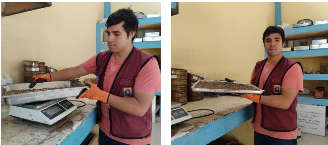
Figura 35. Ensayo para determinar el peso volumétrico de los agregados
