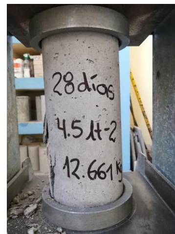
Figura 53. Ensayo a compresión de concreto a 28 días de curado, con la presencia del ingeniero asesor
