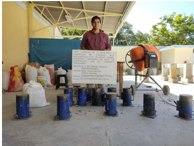
Figura 58. Ensayo a compresión de concreto seco predosificado en laboratorio a 7 días, con la presencia del ingeniero asesor
