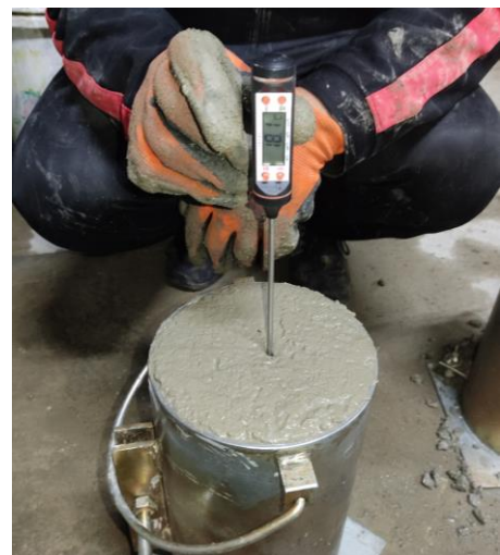
Figura 38. Llenado de concreto seco predosificado a 14 días
