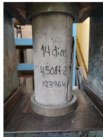
Figura 53. Ensayo a compresión de concreto a 28 días de curado, con la presencia del ingeniero asesor
