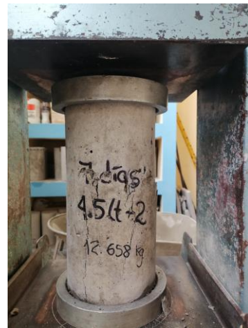
Figura 52. Ensayo a compresión de concreto a 14 días de curado, con la presencia del ingeniero asesor
