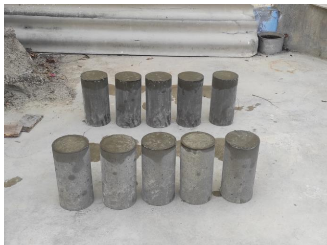
Figura 41. Secado de probetas de concreto antes de ser ensayadas
