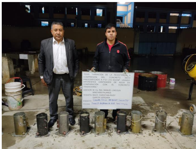
Figura 38. Llenado de concreto seco predosificado a 14 días
