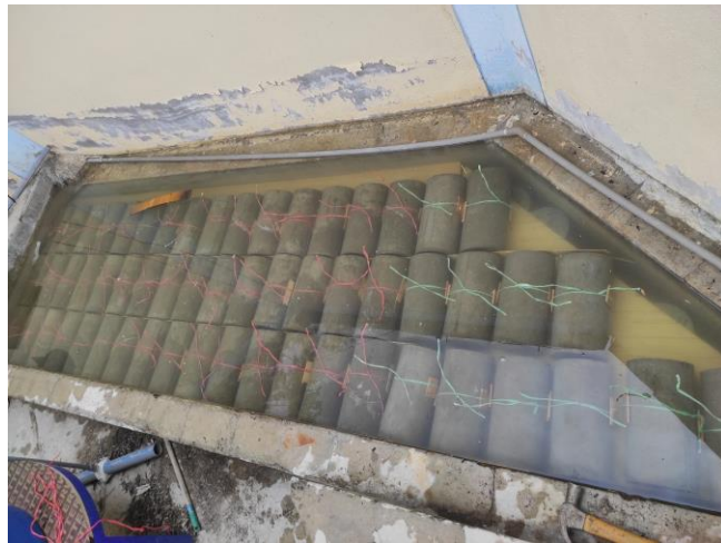
Figura 41. Secado de probetas de concreto antes de ser ensayadas
