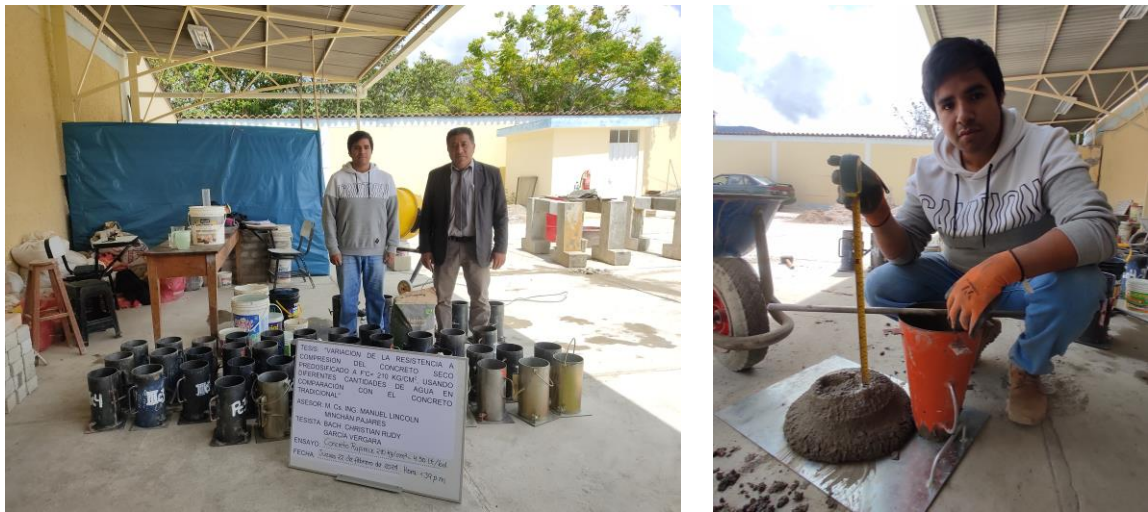
Figura 40. Curado de probetas de concreto
