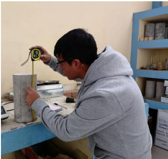
Figura 50. Toma de medidas de las probetas de concreto
