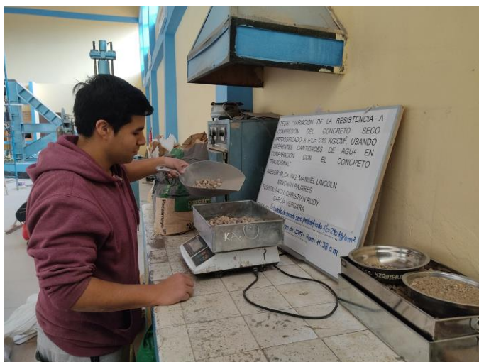
Figura 56. Elaboración del concreto seco predosificado en laboratorio
