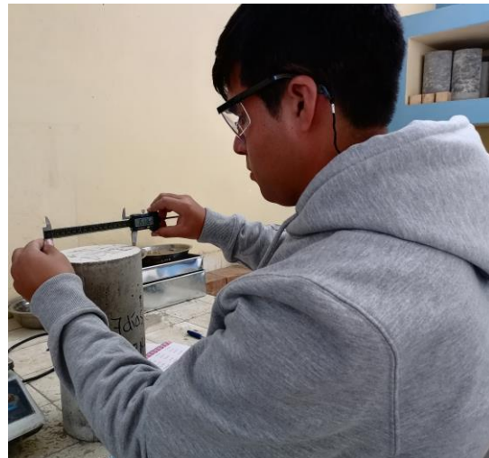
Figura 50. Toma de medidas de las probetas de concreto
