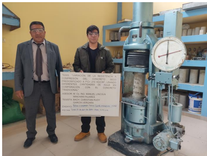
Figura 58. Ensayo a compresión de concreto seco predosificado en laboratorio a 7 días, con la presencia del ingeniero asesor
