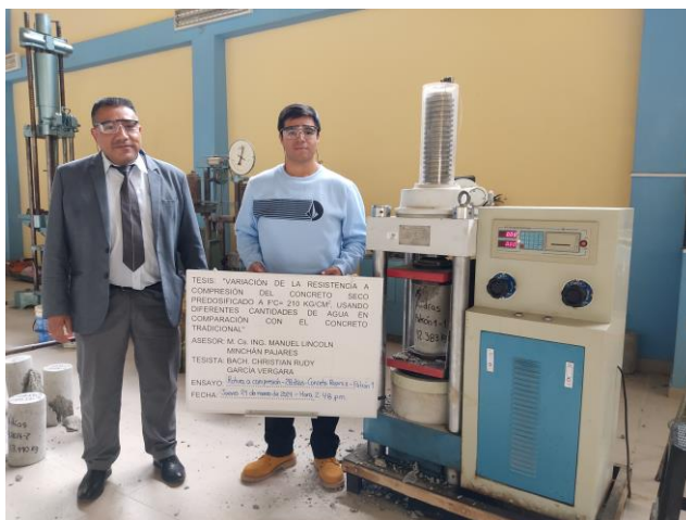
Figura 53. Ensayo a compresión de concreto a 28 días de curado, con la presencia del ingeniero asesor
