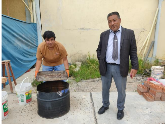
Figura 34. Pesado de los agregados para determinar el contenido de humedad
