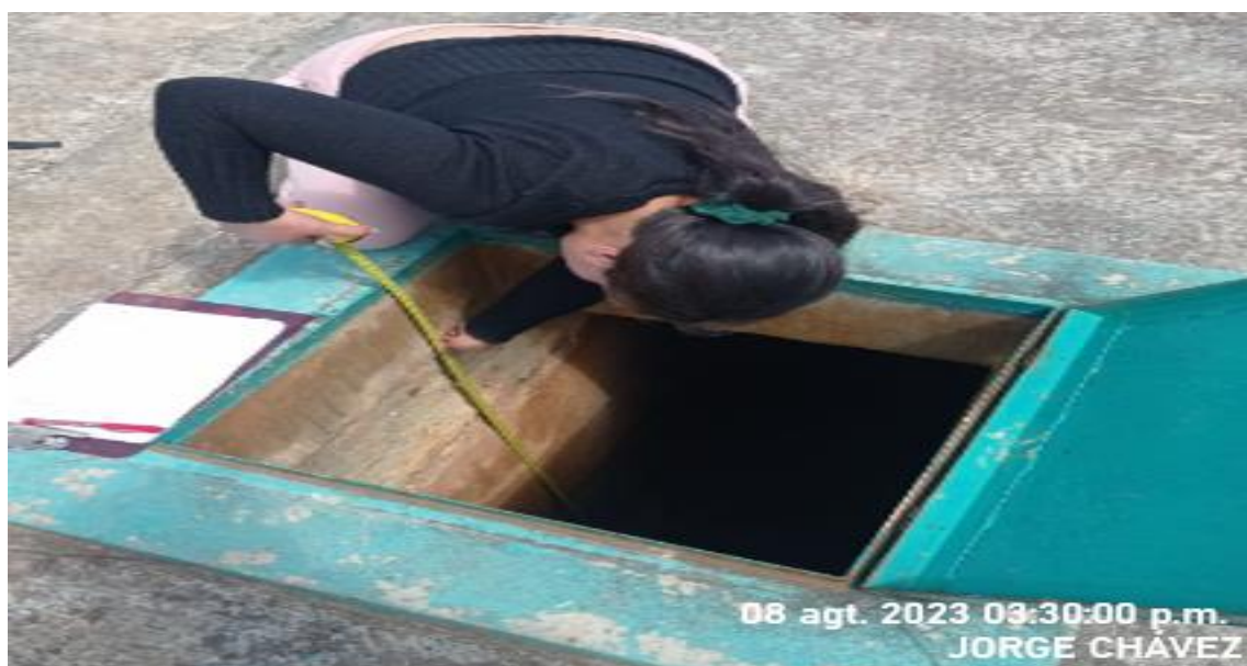
Figura 34 Recopilación del nivel de agua en el reservorio del distrito de Jorge Chávez
