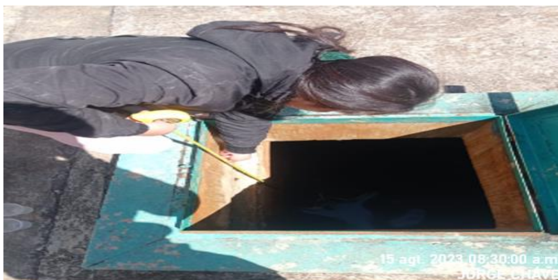
Figura 35 Nivel de agua en el reservorio
