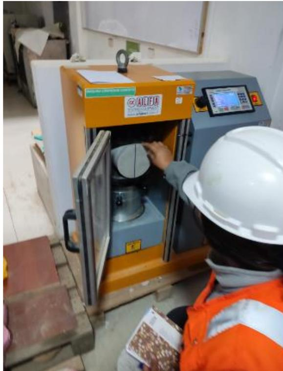
Foto 8: Toma de medidas y pesos de probetas
