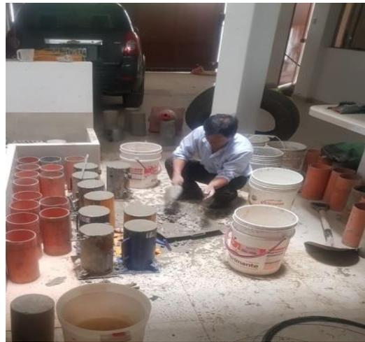
Foto 6: Preparación y curado de probetas
