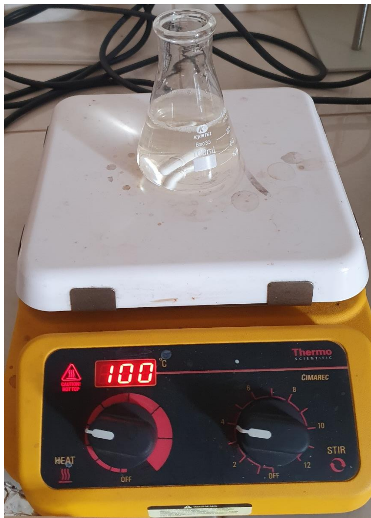
Fig N° 14. Agitador de placa caliente de la marca Thermo Scientific, modelo SP131325, utilizado para la obtención del extracto de las hojas de olivo y para la síntesis de las AgNPs.
