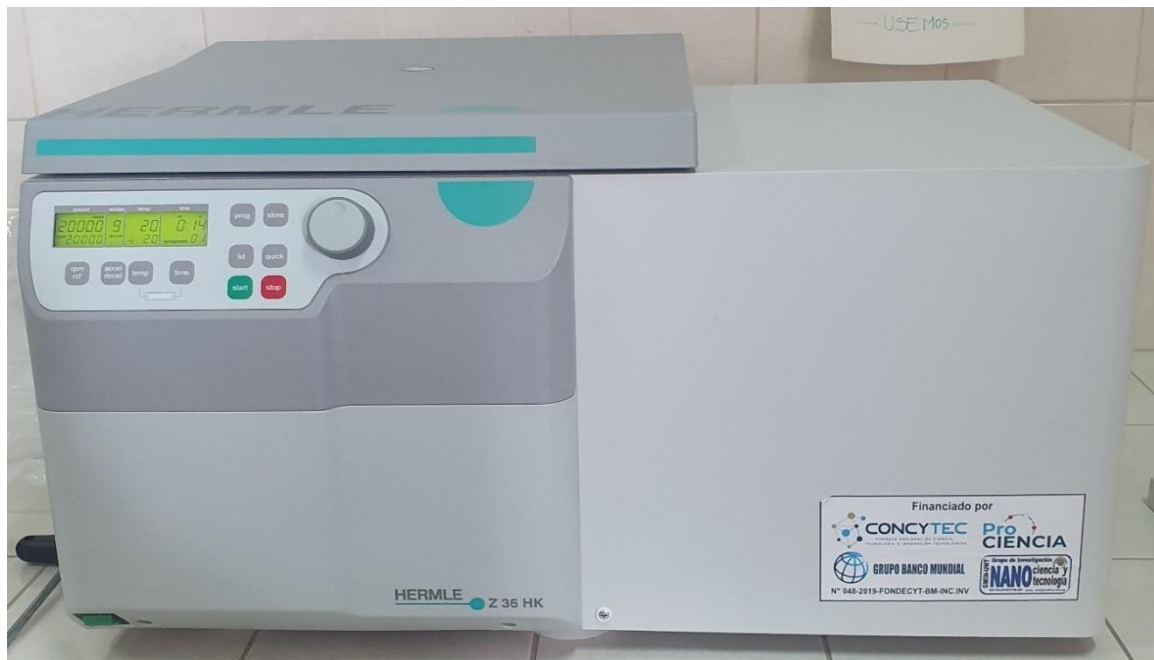
Fig N° 15. Ultracentrífuga de la marca Hermle, modelo Z 36 HK, utilizado para la sedimentación de las AgNPs luego de la síntesis.
