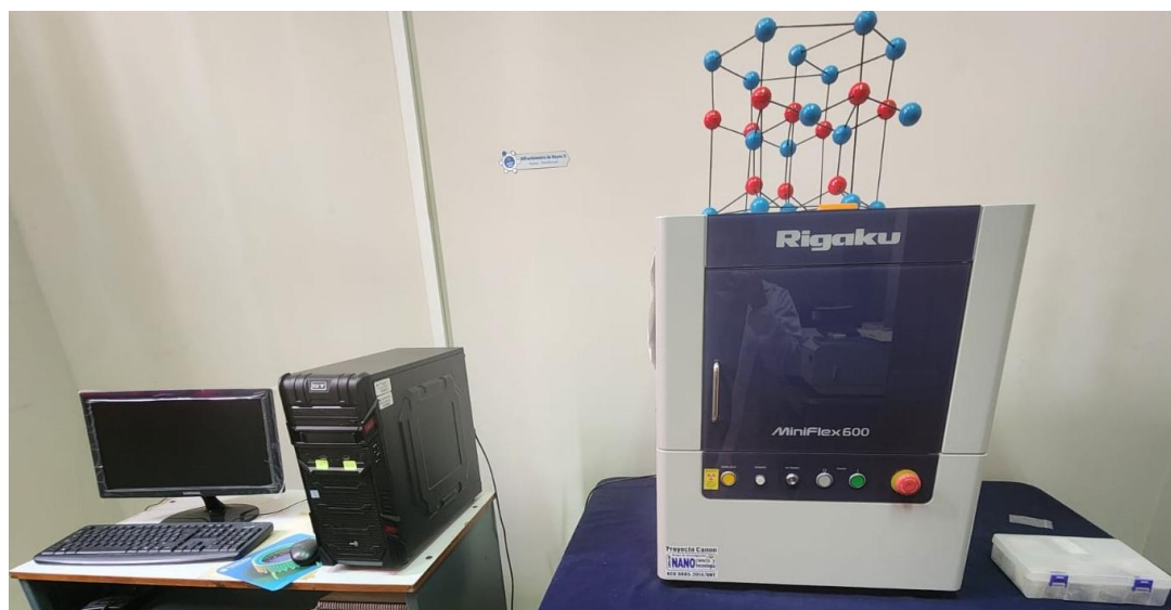
Fig N° 18. Difractómetro de rayos X de la marca Rigaku, modelo MiniFlex600, utilizado para la caracterización cristalina de las AgNPs.
