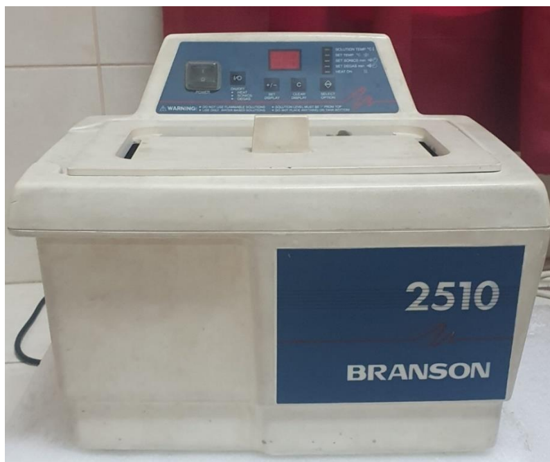
Fig N° 16. Ultrasonicador la marca Branson, modelo 2510-DTH, utilizado para los lavados y la dispersión de las AgNPs.
