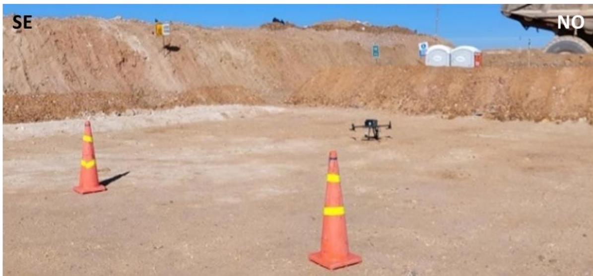
Figura 28. Dron Industrial Modelo M300 RTK, utilizado para el proceso de fotogrametría.
