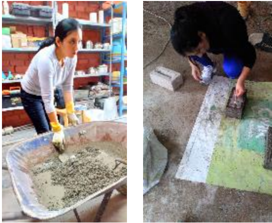
Figura 15: Elaboración de ladrillos de PET y cemento, en mesa vibradora.
