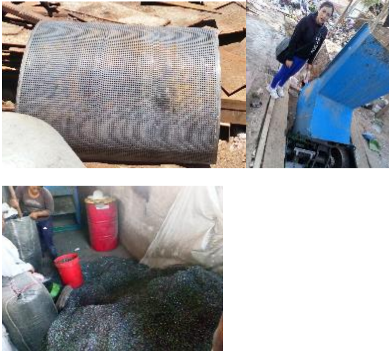
Figura 11: La primera imagen zaranda fabricada para obtener picadillo de tamaño máximo de 4mm, segunda imagen la máquina industrial para realizar el picado de plástico PET(Polietileno-tereftalato) tercera imagen el picadillo de PET, enero 2020.
