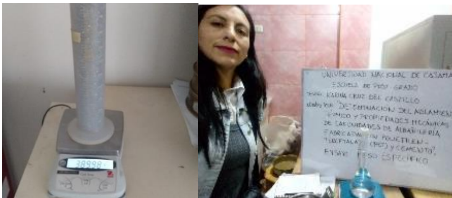
Figura 12: Peso del material más probeta, para obtener el peso específico aparente del PET.
