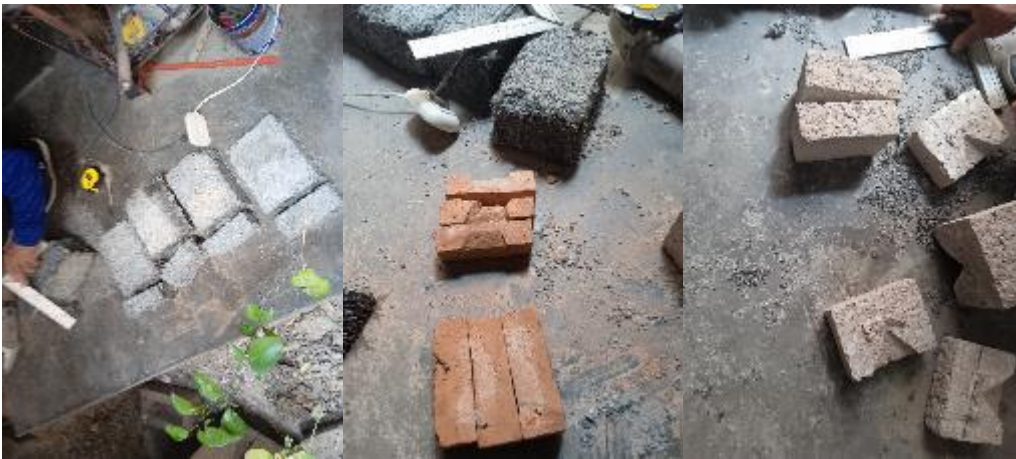
Figura 22: Selección y corte de muestras para realizar el ensayo de conductividad térmica de ladrillos de PET y cemento, ladrillos de arcilla y ladrillos de concreto artesanal.
