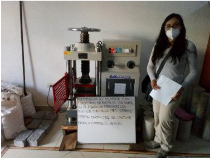
Figura 17: Ensayo a compresión.
