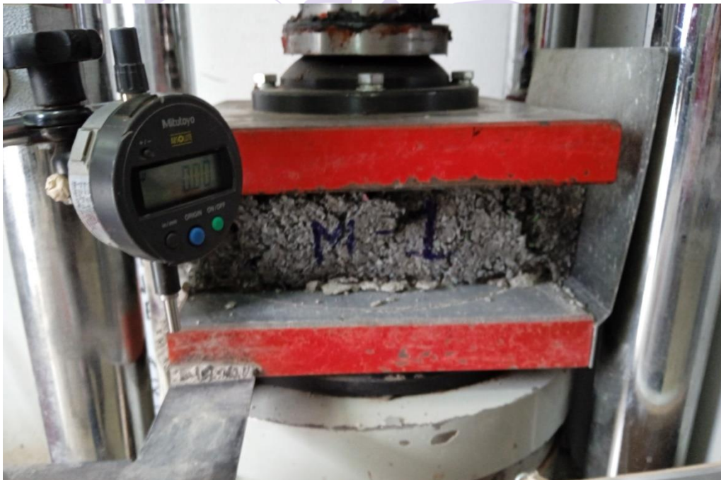
FOTOGRAFÍA N°2. Rotura de la UNIDAD DE ALBAÑILERÍA M-1 , después del ensayo de compresión uniaxial [N° DE TESTIGO: 1].
