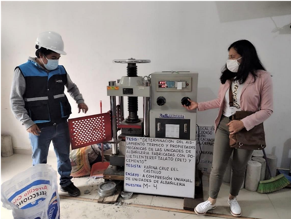
FOTOGRAFÍA N°7. Ensayo de compresión uniaxial de la UNIDAD DE ALBAÑILERÍA M-4 [N° DE TESTIGO: 4]
