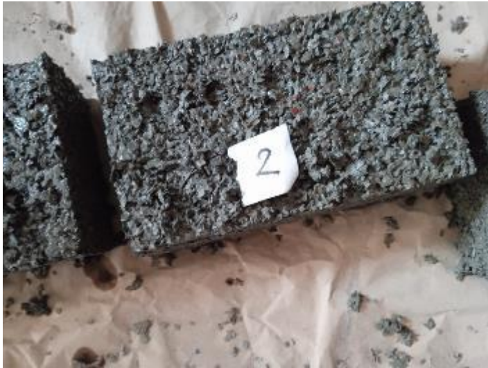
Figura 19: Ladrillos elaborados en molde con botadora y 10 hendiduras de 5 líneas, ladrillo realizado en máquina vibradora, con batidora para el mortero.
