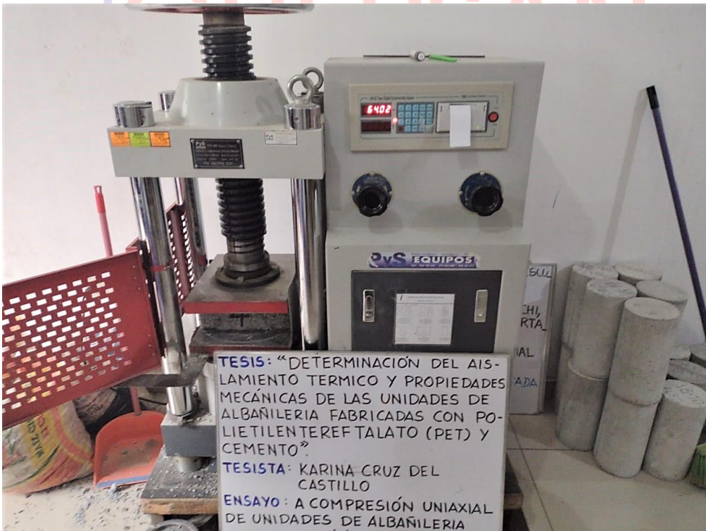
FOTOGRAFÍA N°8. Ensayo de compresión uniaxial de la UNIDAD DE ALBAÑILERÍA M-4 [N° DE TESTIGO: 4]
