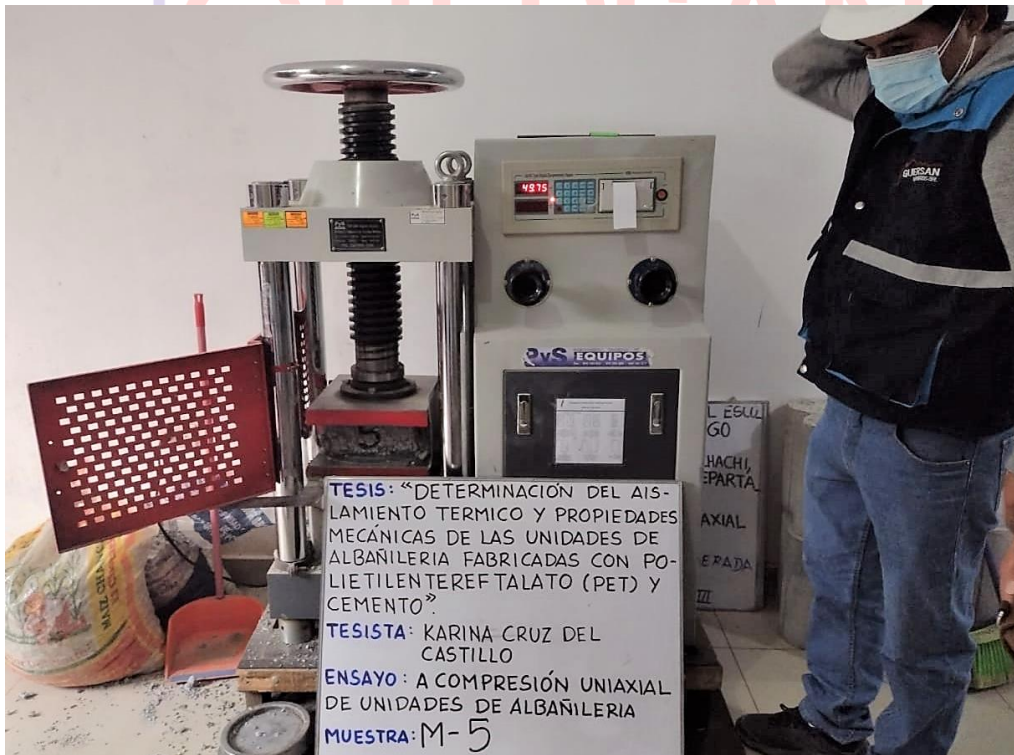
FOTOGRAFÍA N°10. Ensayo de compresión uniaxial de la UNIDAD DE ALBAÑILERÍA M-5 [N° DE TESTIGO: 5]
