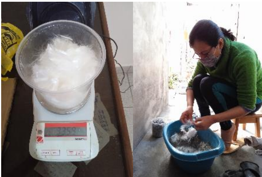
Figura 20: Incorporación de fibras sintéticas en la fabricación de ladrillos de PET y cemento.
