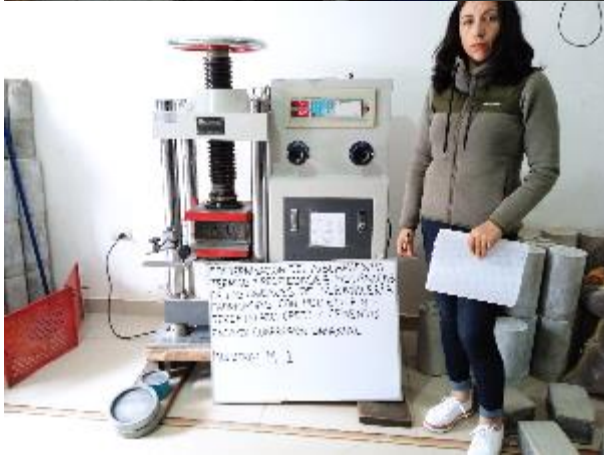
Figura 25: Medición de propiedades físicas-alabeo y mecánicas-resistencia a compresión.
