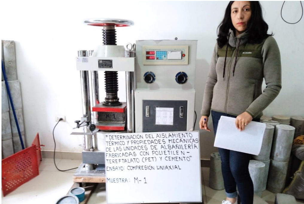
FOTOGRAFÍA N°1. Ensayo de compresión uniaxial de la UNIDAD DE ALBAÑILERÍA M-1 [N° DE TESTIGO: 1].
