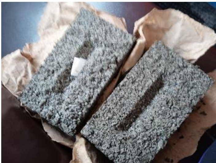
Figura 18: Ladrillos elaborados en molde con botadora y cuña de 1,5cm, ladrillo realizado en máquina vibradora, con batidora para el mortero.
