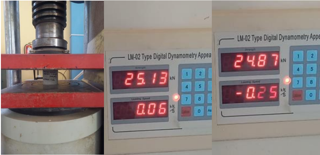
Fotografía N°11. Ensayo a compresión a las 24 horas
