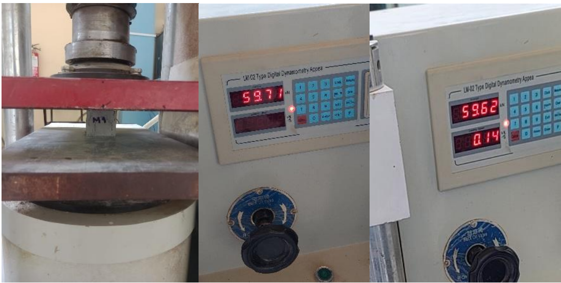
Fotografía N°12. Ensayo a compresión a los 7 días
