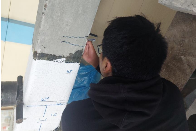
Fotografía N°35. Verificación del comportamiento de la Falla al corte de Viga (Pórtico PS-02)
