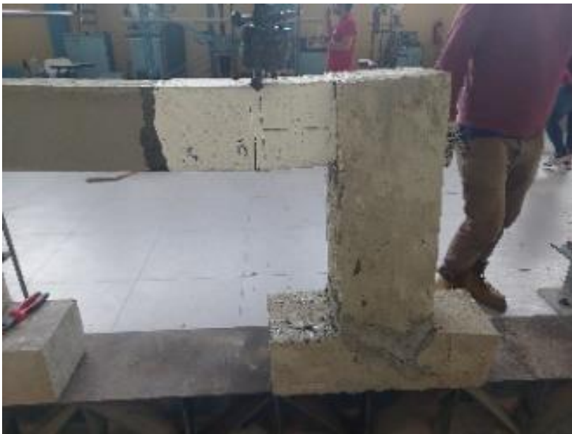
Fotografía N°38. Verificación del comportamiento de la Falla al corte de Viga (Pórtico PF-02)
