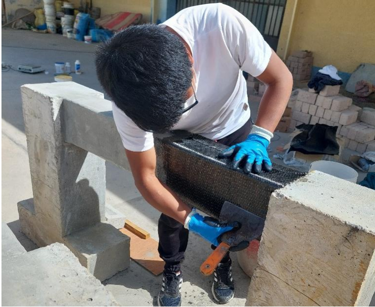
Fotografía N°25. Con ayuda de una espátula, se aplana bien la tela eliminando arrugas o bolsas de aire
