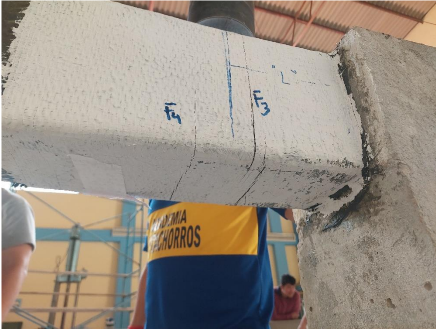
Fotografía N°37. Verificación del comportamiento de la Falla al corte de Viga (Pórtico PF-01)
