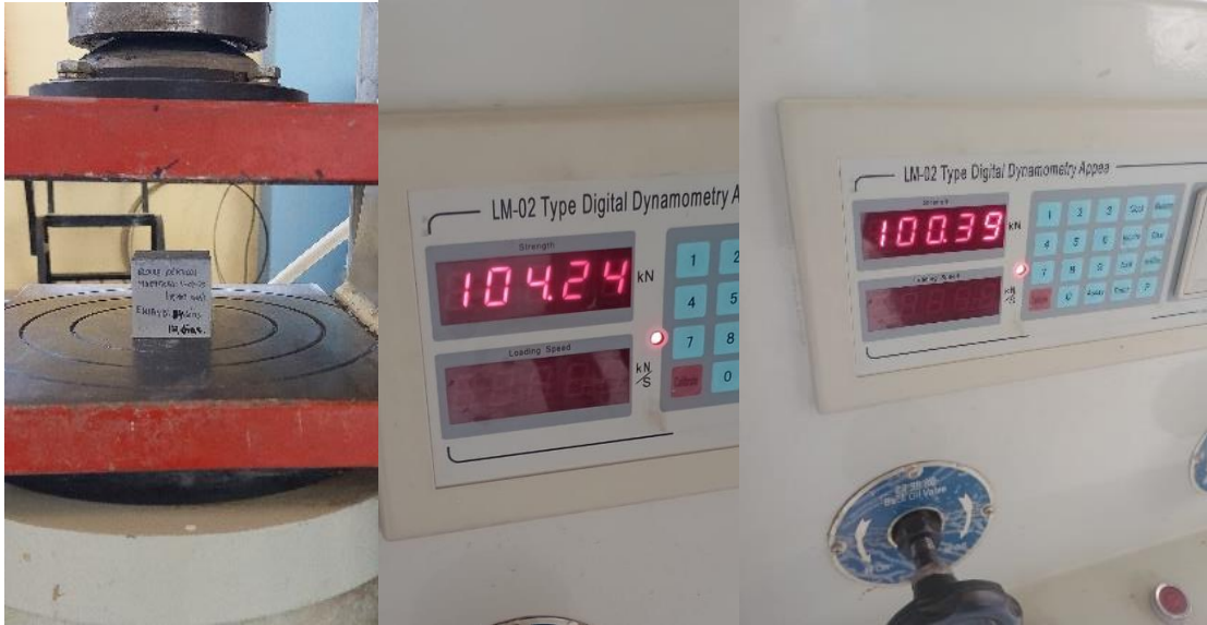
Fotografía N°13. Ensayo a compresión a los 14 días
