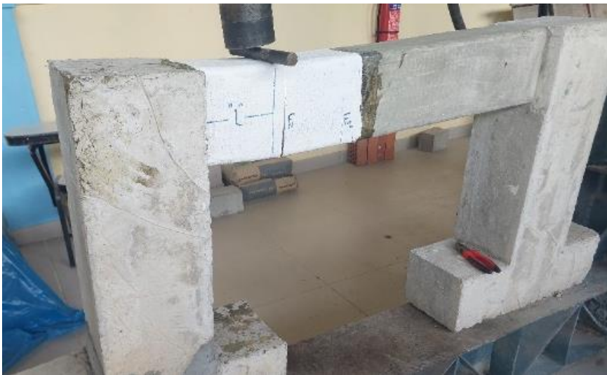
Fotografía N°32. Ensayo de pórtico PF-02
