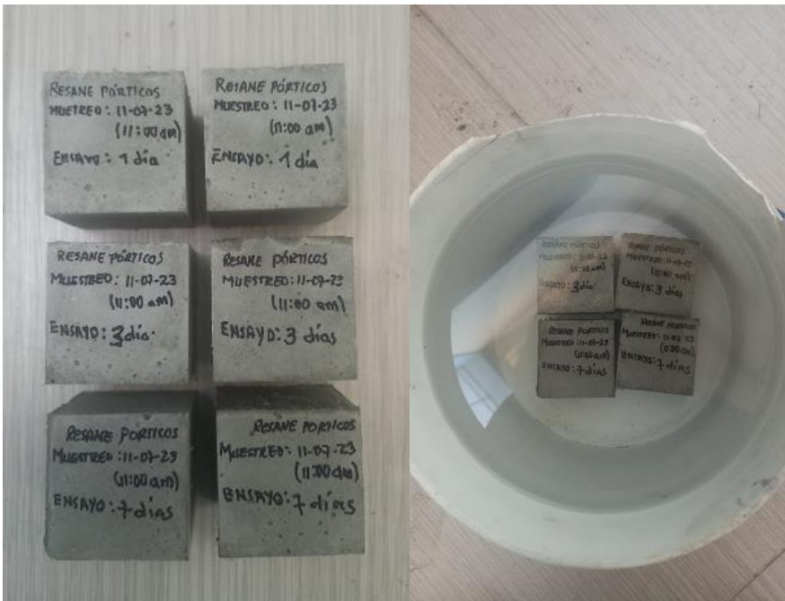
Fotografía N°10. Identificación y curado de muestras de mortero
