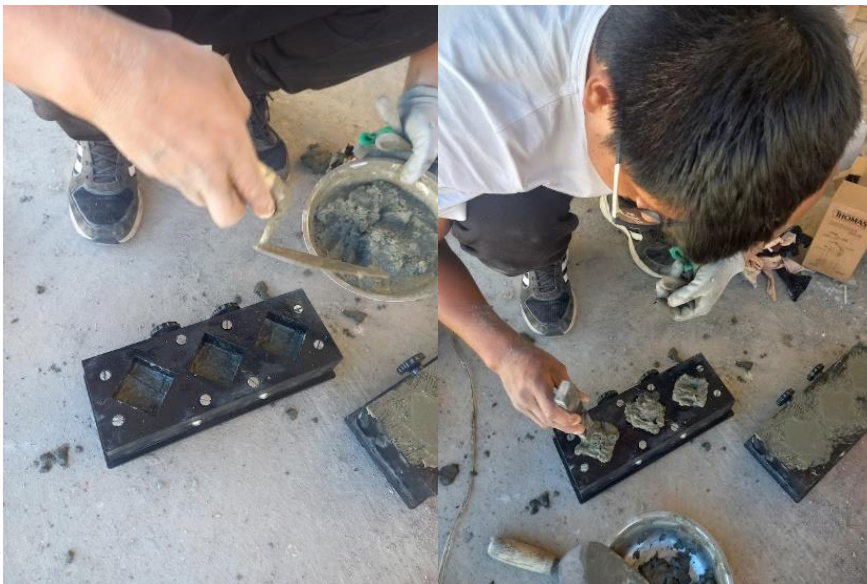
Fotografía N°08. Muestreo de mortero de reparación – ASTM C 109/109M
