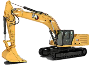
Excavadora CAT 320 D2L
