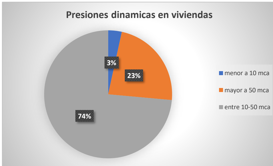
Gráfico 3: presiones dinámicas en viviendas medidas con manómetro
