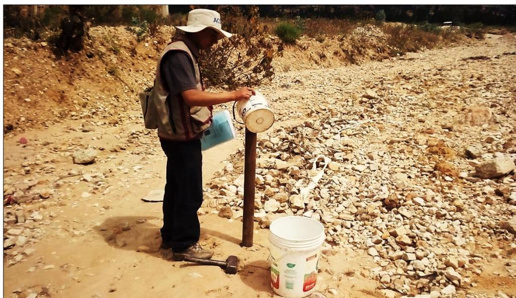
Foto 10. Ensayo de infiltración, sobre sedimentos de origen fluvial en la quebrada Agocucho.
