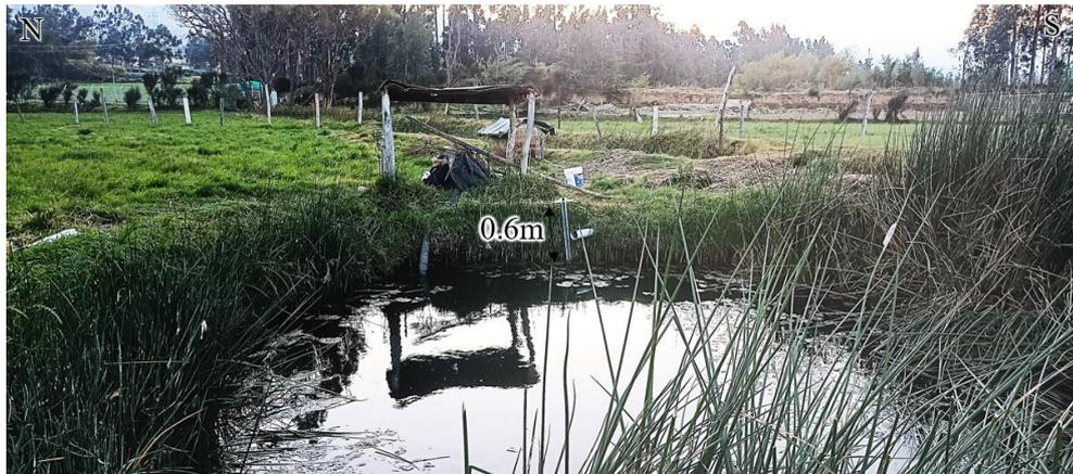
Foto 7. Acuífero poroso en sedimentos no consolidados, donde se observa la profundidad de la napa freática a 0.6m de profundidad.
