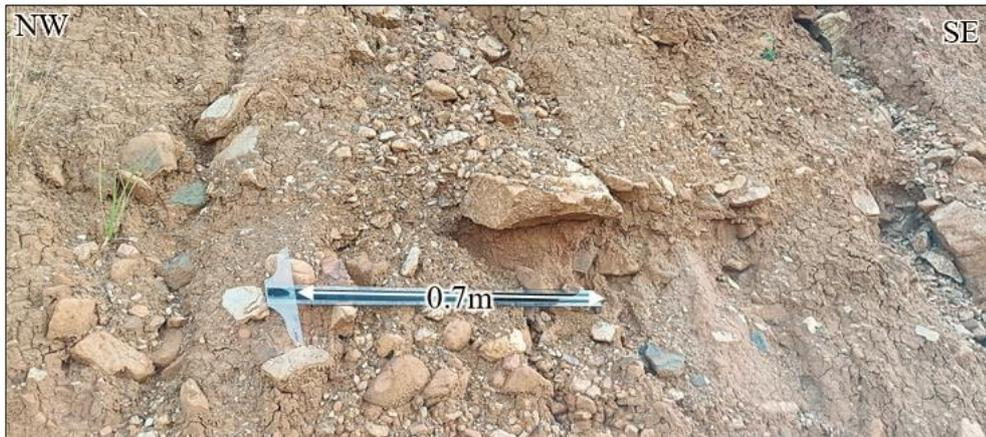
Foto 3. Se observa la presencia de clastos heterogéneos de tamaño entre 5cm a 40cm, mal clasificados y con clastos angulosos a subangulosos.
