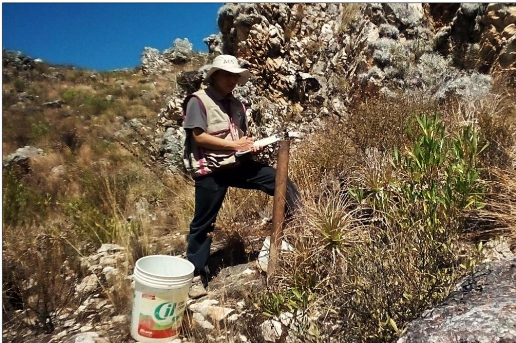
Foto 9. Ensayo de infiltración sobre la Formación Chimú, que presenta estratos fuertemente fracturados.
