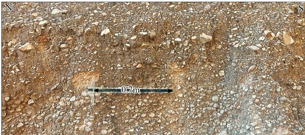
Foto 5. Depósito aluvio-fluvial ubicado en la quebrada Agocucho, conformado por sedimentos de limos, gravas y cantos heterogéneo subangulosos a subredondeados.
