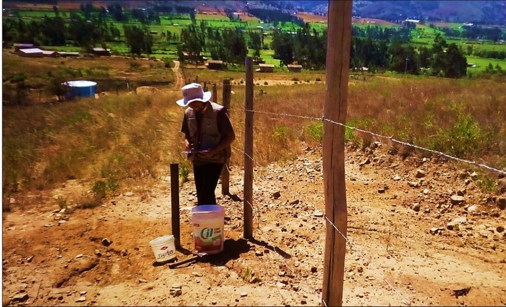
Foto 8. Ensayo de infiltración, para determinar la conductividad hidráulica en depósitos no consolidados.
