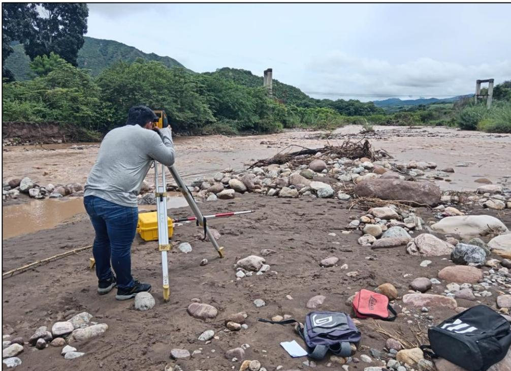
*Figura N°43. Levantamiento topográfico del cauce aguas abajo.*
