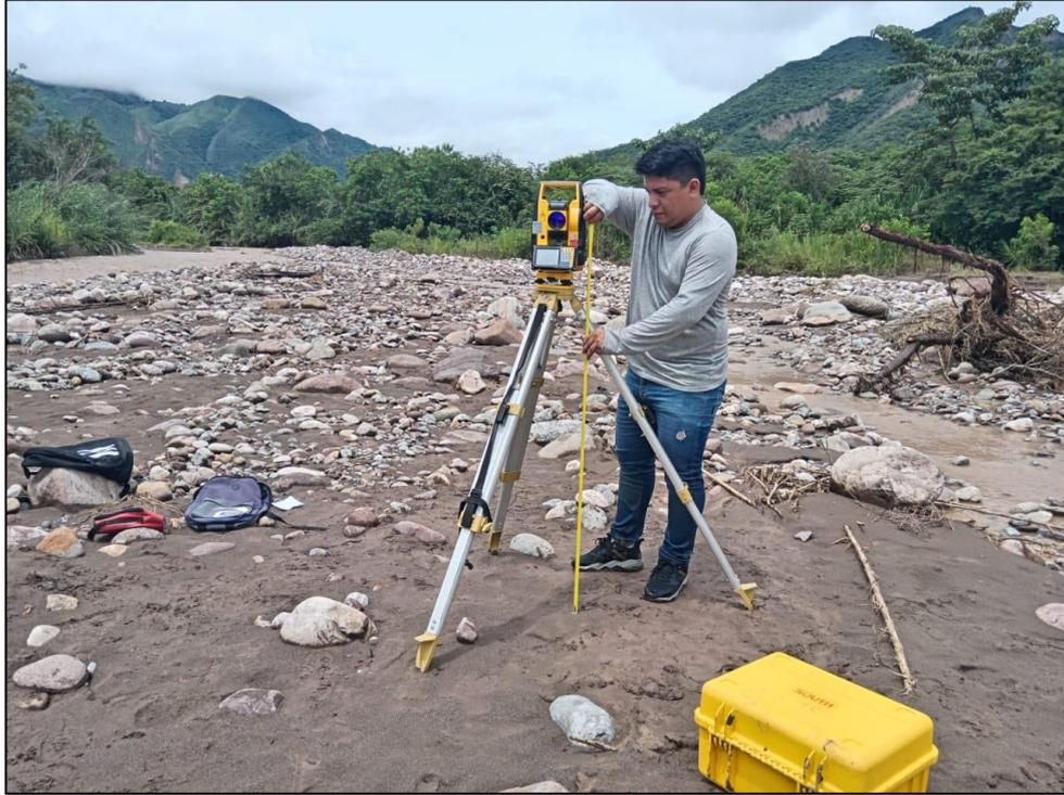
*Figura N°42. Medida de Altura de Instrumento para el Levantamiento Topográfico.*
