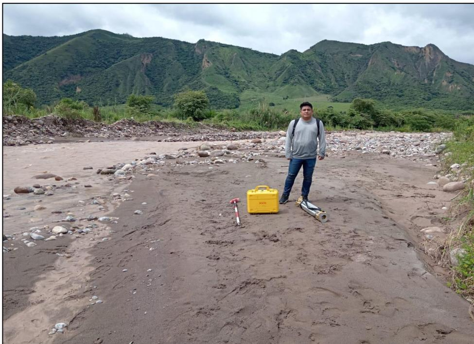
*Figura N°40. Reconocimiento de la zona de estudio e instalación de la estación total para el levantamiento topográfico del cauce de la quebrada Tataque.*
