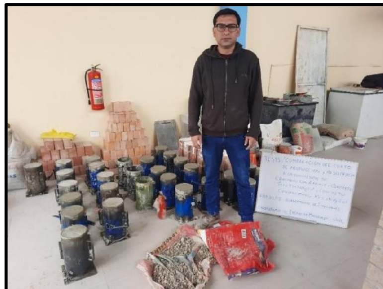
Foto.N°14. Se muestra en la imagen los especímenes de concreto en los moldes normalizados, tanto del concreto Rapimix f'c= 210 \text{ kg/cm}^2 , así como del concreto convencional f'c= 210 \text{ kg/cm}^2 .
