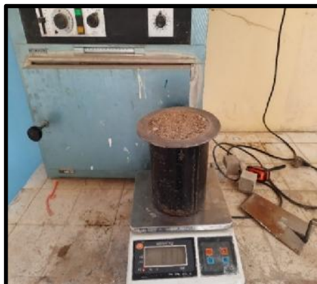
Foto.N°2. Análisis granulométrico-realizando el peso correspondiente del material retenido del agregado grueso en él tamiz.
