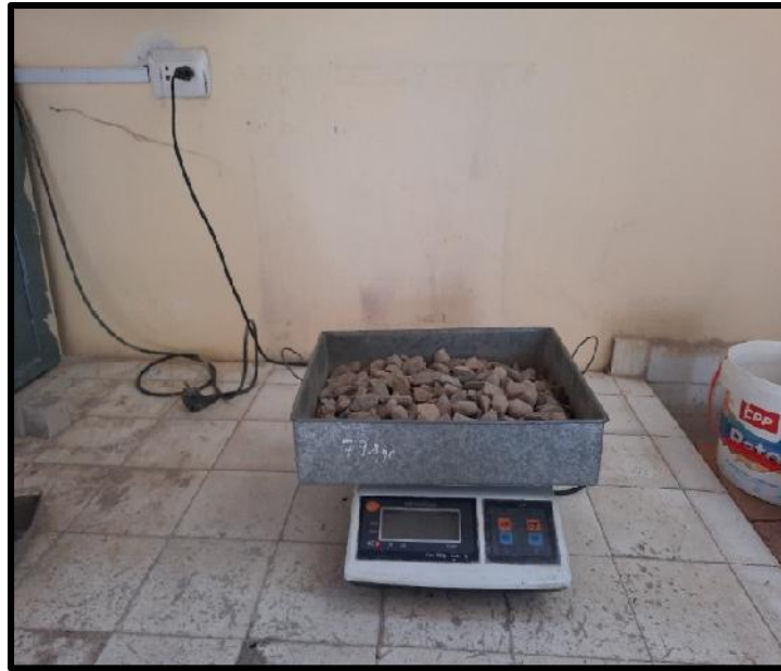
Foto.N°7. En la figura se visualiza pesando el agregado grueso.
