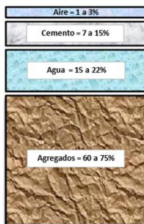
Figura 1. Elementos que conforman el concreto, volúmenes absolutos
