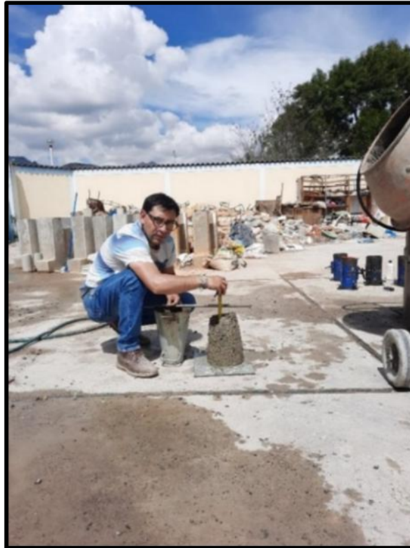
Foto.N°13. Elaboración y ensayo de asentamiento del concreto Rapimix f'c= 210 \text{ kg/cm}^2 .
