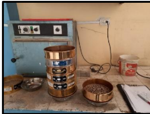
Foto.N°1. Realizando el análisis granulométrico del agregado grueso con el uso de los tamices correspondientes y recolectando los datos en las fichas.
