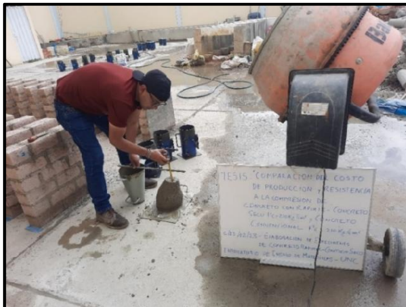
Foto.N°12. Realizando el ensayo de asentamiento y medida de slump del concreto convencional f'c = 210 \text{ kg/cm}^2 .
