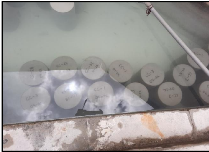
Foto.N°15. Curado de especímenes de concreto cada uno de ellos codificados adecuadamente de acuerdo al tipo.
