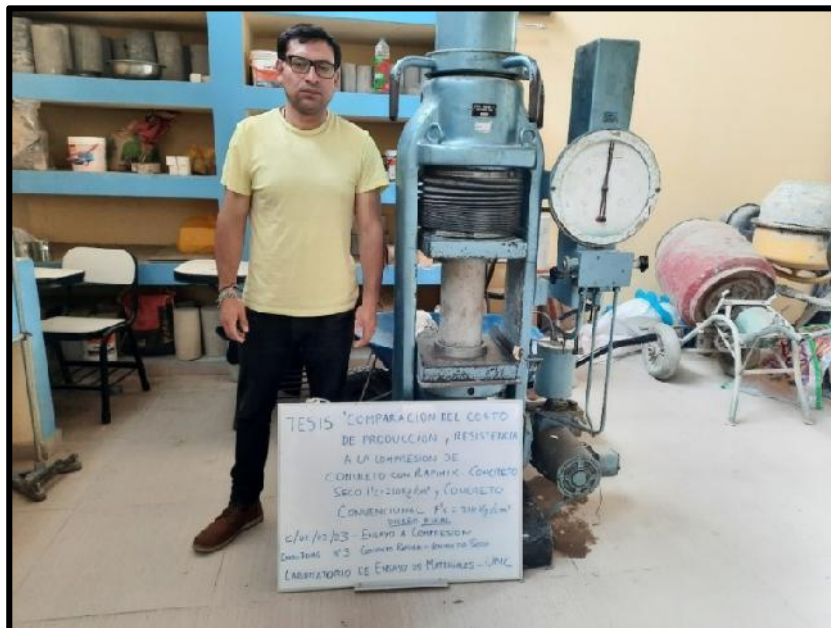
Foto.N°16. Ensayo a compresión del concreto convencional f'c = 210 \text{ kg/cm}^2 .
