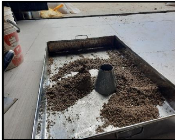
Foto.N°5. Realizando el ensayo de contenido de humedad del agregado fino.
