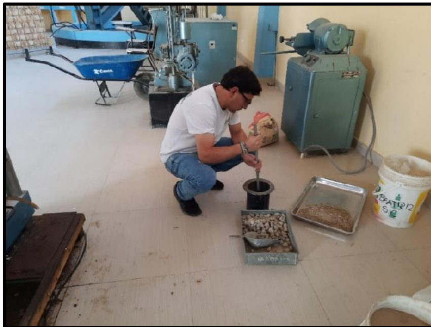
Foto.Nº10. Realizando el ensayo de peso unitario compactado del agregado grueso.
