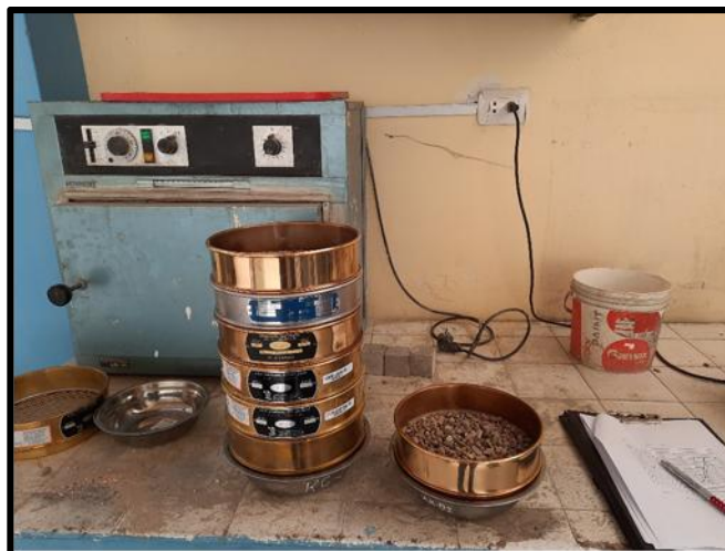
Foto.N°5. Realizando el ensayo de contenido de humedad del agregado fino.
