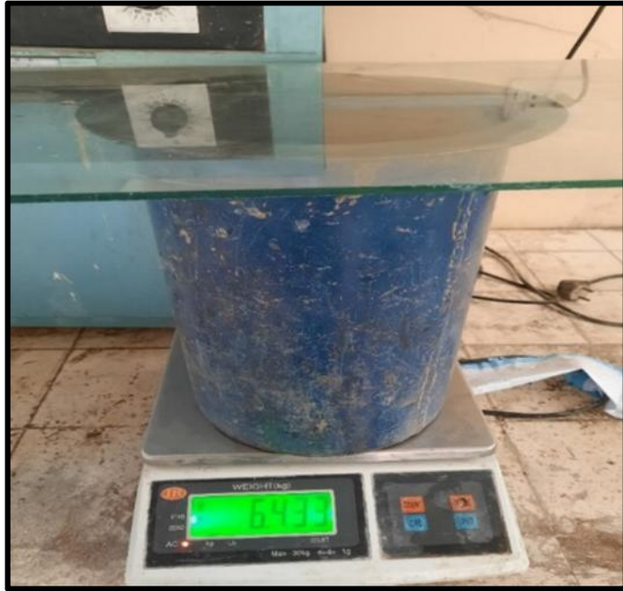
Foto.Nº9. En la figura se observa el peso del molde utilizado en el ensayo de peso unitario, esto nos sirve para determinar el factor “f”.
