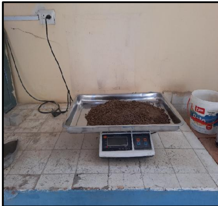
Foto.N°8. En la figura se visualiza pesando el agregado fino.
