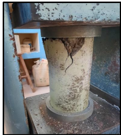
Foto.N°18. Fallas de los especímenes después del ensayo a compresión del concreto.
