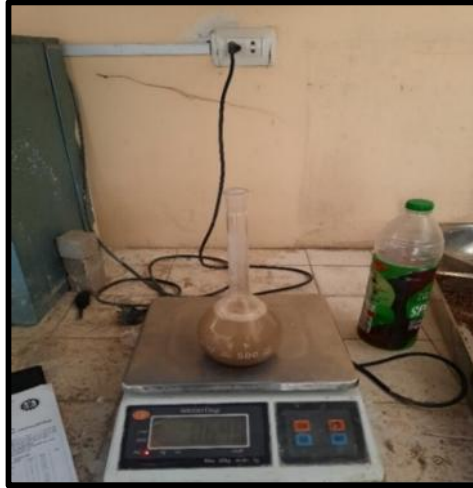
Foto.N°4. Pesando la fiola más la respectiva cantidad de agregado fino para realizar el ensayo de peso específico de masa del agregado fino.
