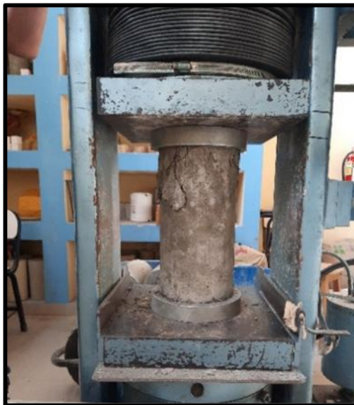
Foto.N°18. Fallas de los especímenes después del ensayo a compresión del concreto.
