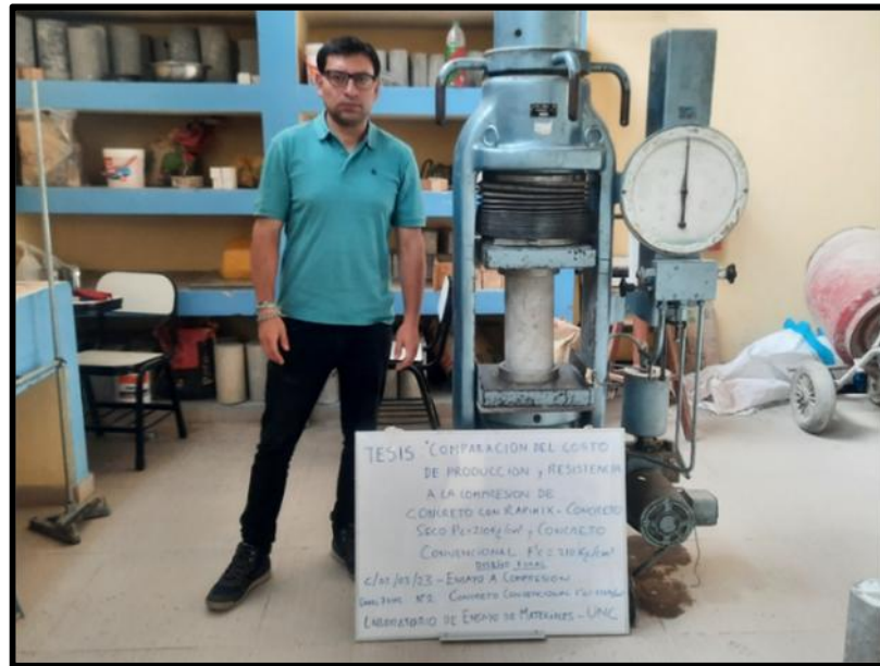
Foto.N°17. Se observa la Ensayo a compresión del concreto f'c = 210 \text{ kg/cm}^2 tipo I.
