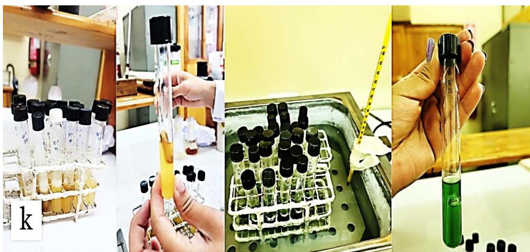
Fotografía k: Procedimiento de análisis para Coliformes : Se siembran tubos con caldo lactosado y campana de Durham. Después de incubar a 36 °C por 18-24 horas, los tubos positivos para coliformes totales mostrarán turbidez y gas en la campana. Estos tubos positivos se siembran en caldo verde brillante con nueva campana. La presencia de gas después de incubar a 36 °C por 18-24 horas confirma coliformes fecales. Finalmente, los positivos en caldo verde brillante se incuban a 44 °C por 18-24 horas.
