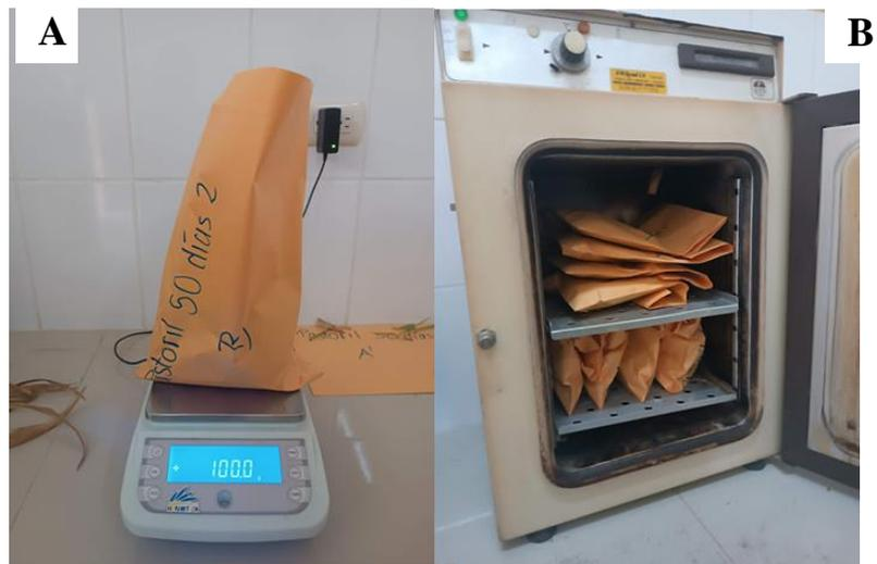
**Anexo 23 (Figura 2):** Evaluación de materia seca **A:** Pesaje de la muestra a procesar. **B:** Muestras en la estufa para respectiva desecación.
