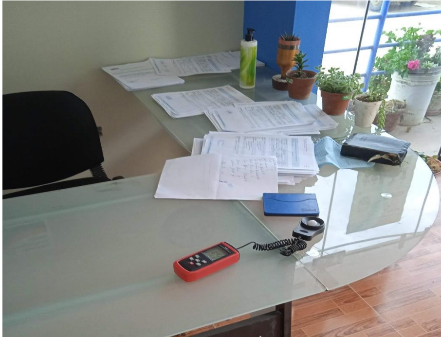
Figura 23- Medición de la iluminación
