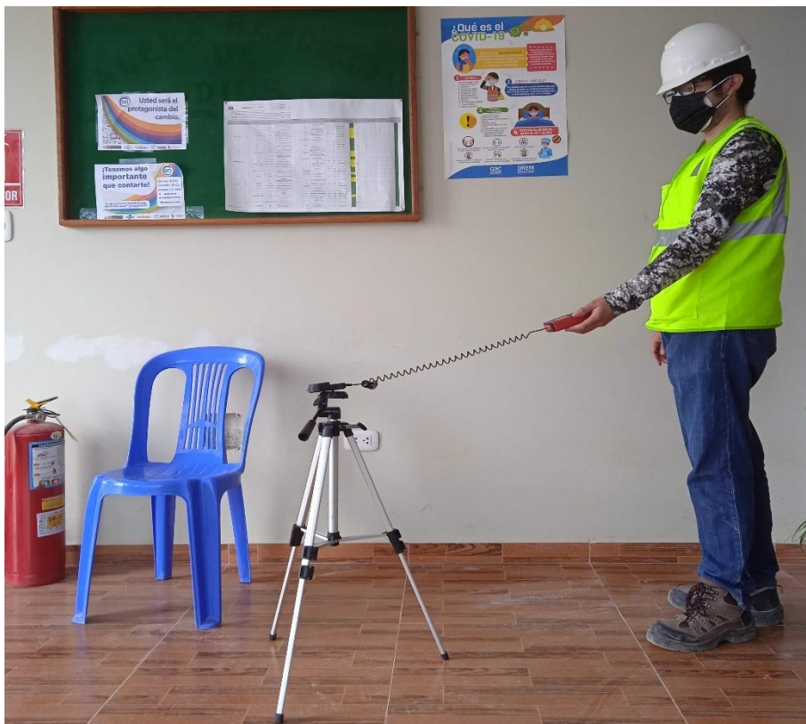
Figura 24 - Medición de la iluminación
