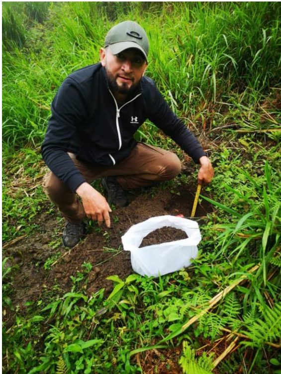
Foto 6. Medición de profundidad para extracción de muestra de suelo de pasto
