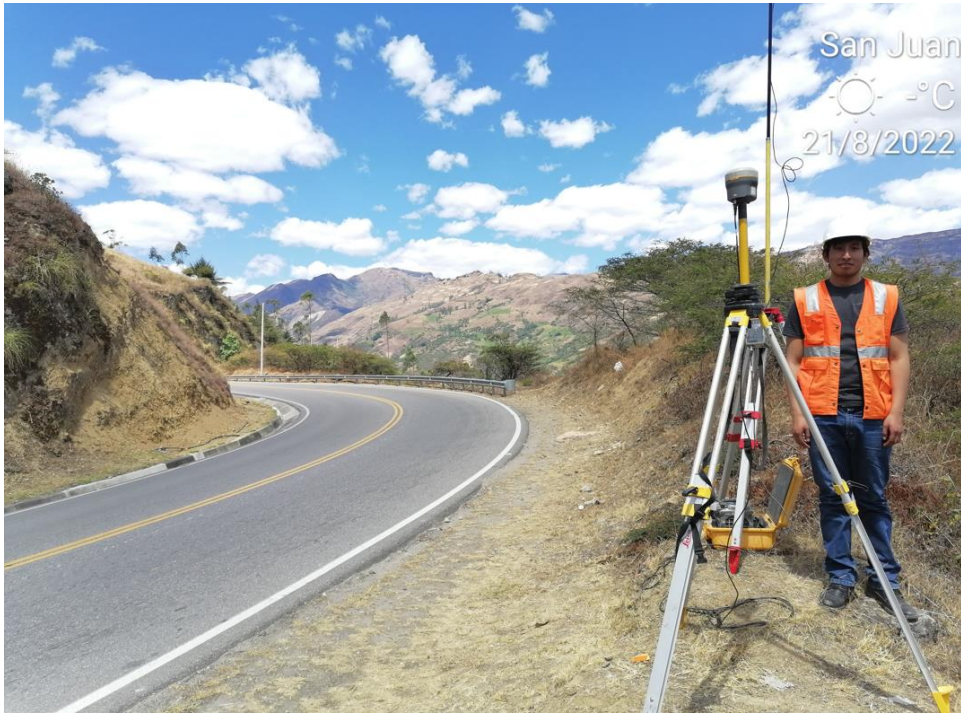
Figura 41: Fotografía del estacionamiento de la base del GPS Diferencial.
