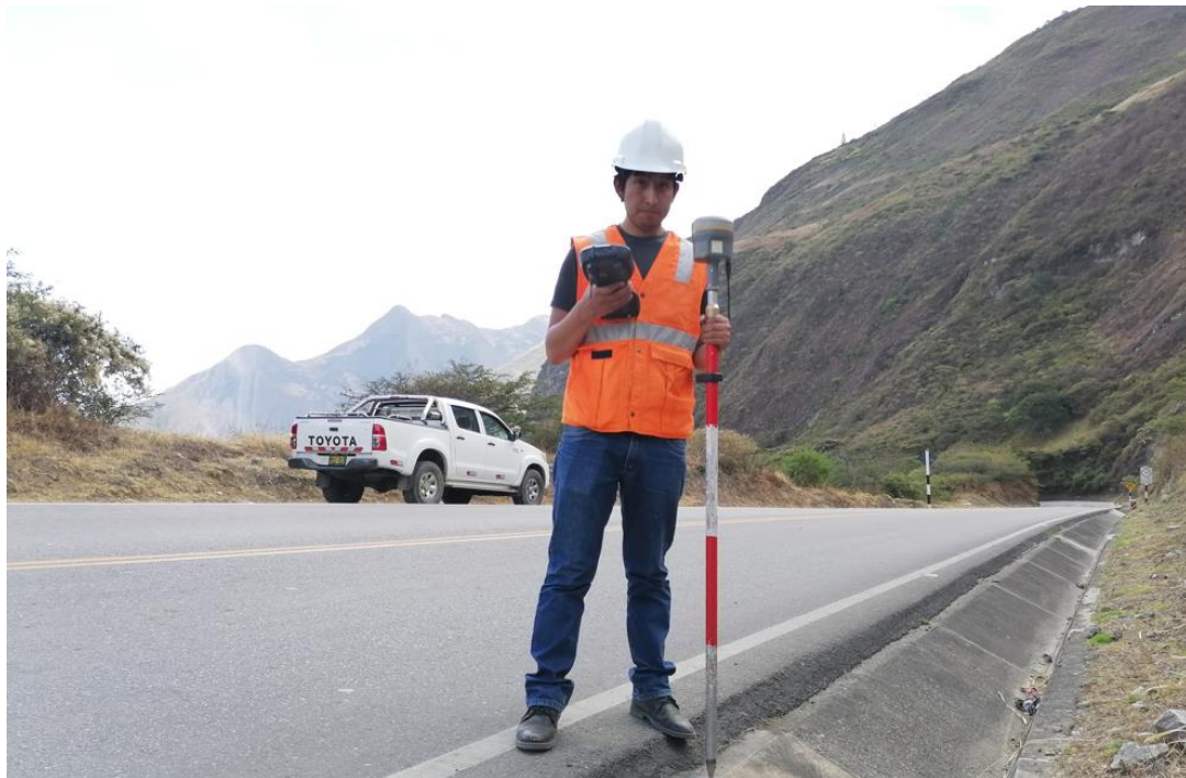
Figura 48: Fotografía del levantamiento de anchos de bermas
