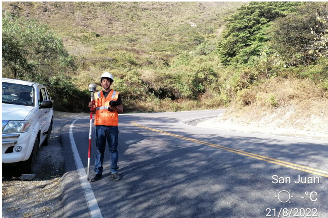
Figura 47: Fotografía del levantamiento del ancho de carril.
