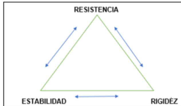
Figura N° 04: Exigencias de la Seguridad Estructural
