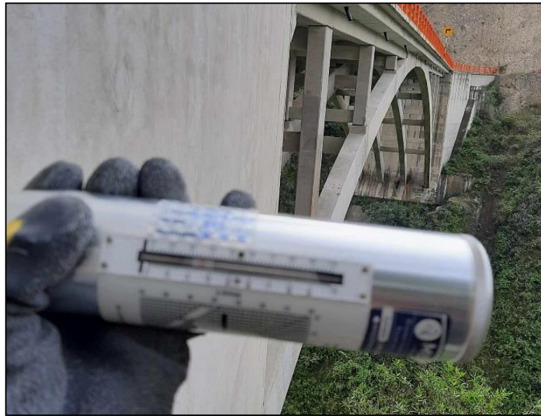
Figura N° 17: Mediciones con Esclerómetro
