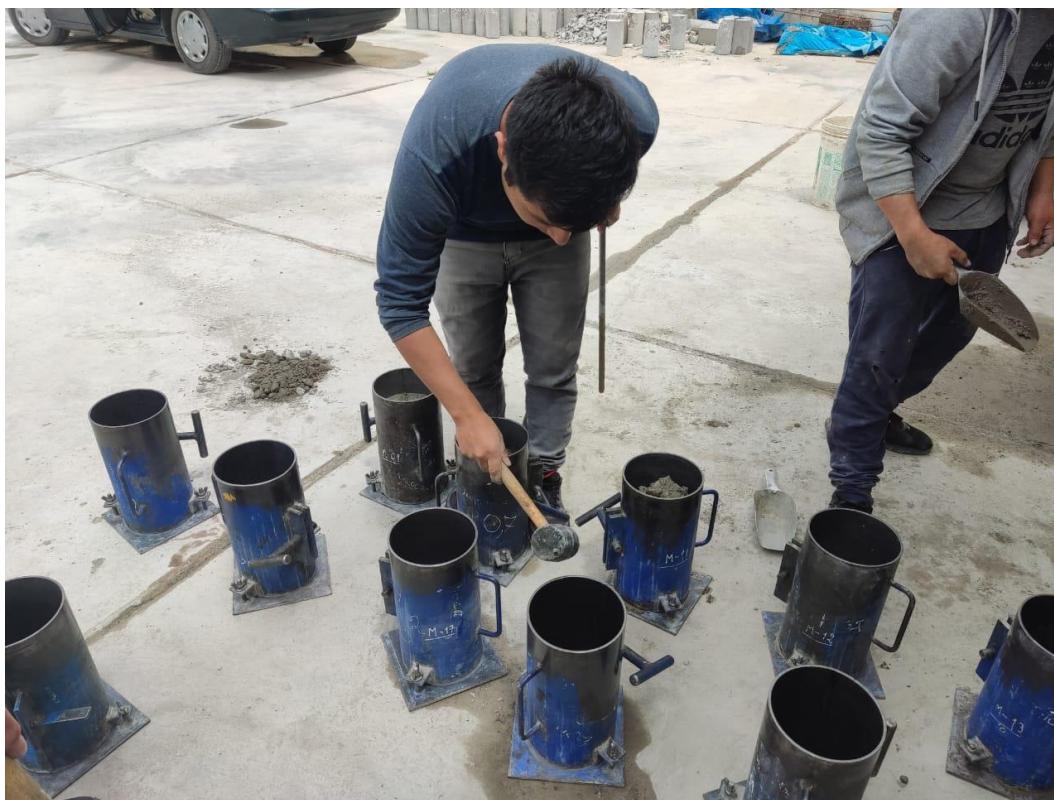
Figura 11. Golpeo con martillo de goma durante el llenado en probetas de estudio
