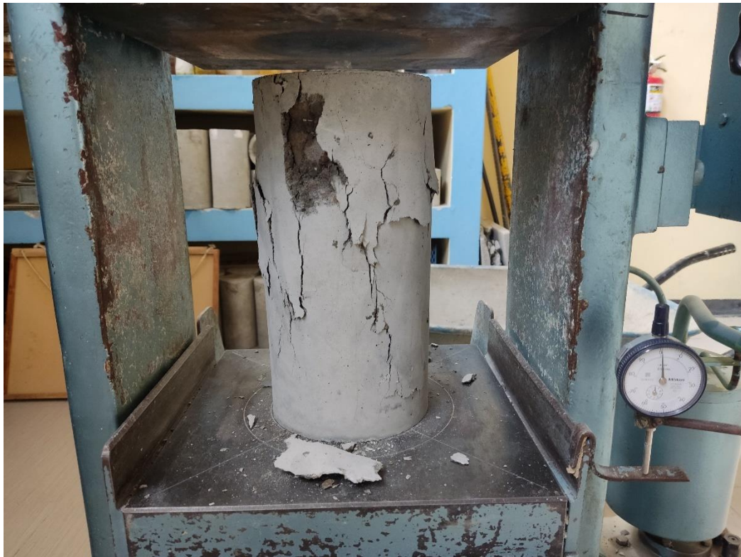
Figura 17. Ensayo de probeta midiendo la deformación unitaria
