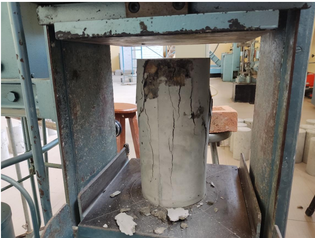
Figura 16. Rotura de probetas de estudio
