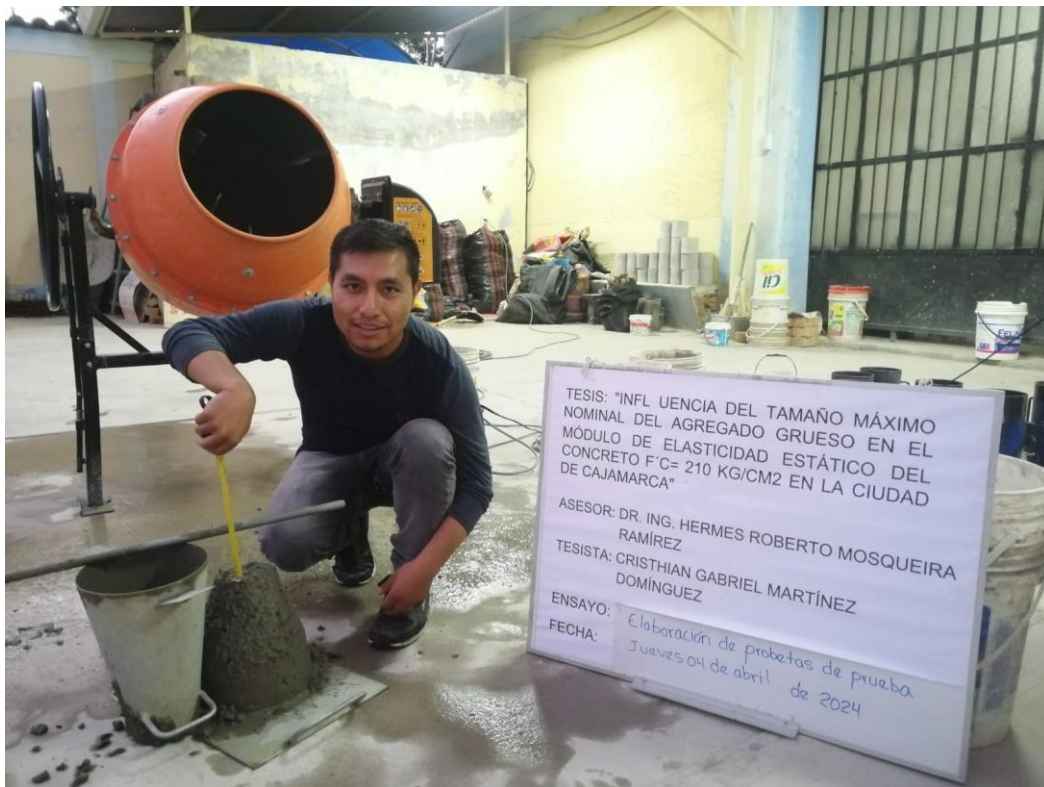
Figura 9. Medición de asentamiento para probetas de estudio
