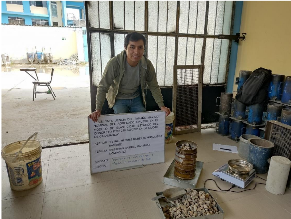
Figura 7. Ensayo de propiedades físico-mecánicas de agregados (granulometría)
