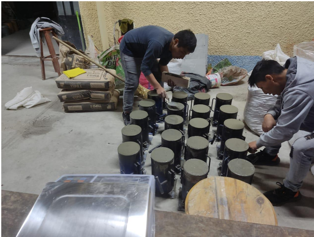
Figura 13. Refrentado de probetas con pasta de cemento
