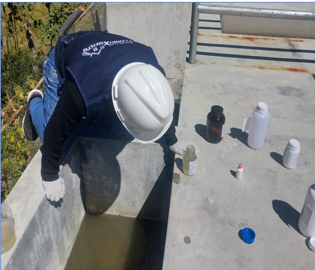
A8. Toma de muestras a la salida del Tanque Imhoff
