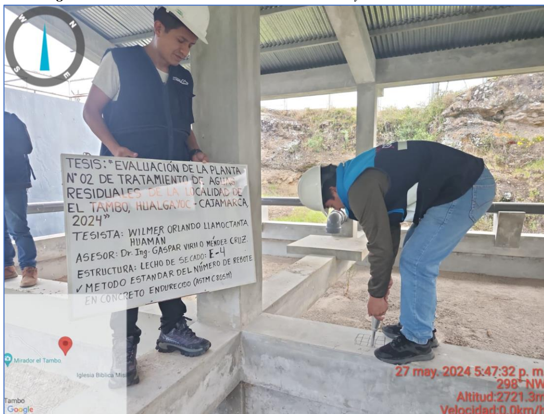
Figura 61. Uso vertical del esclerómetro en el ensayo 02 del lecho de secado
