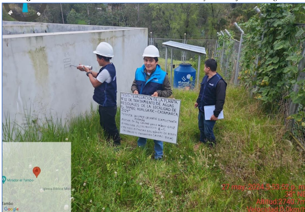
Figura 62. Uso horizontal del esclerómetro en el ensayo 01 del filtro biológico
