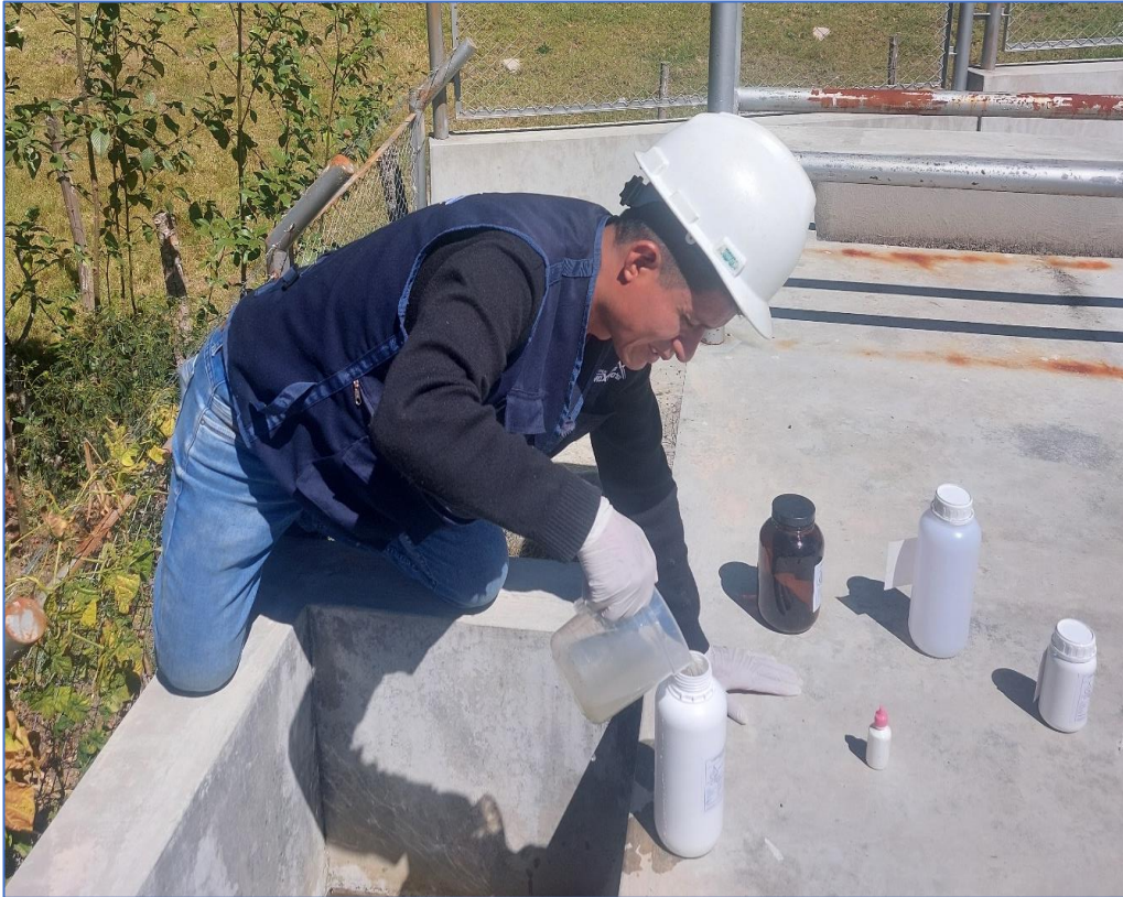
A7. Toma de muestras en la salida del tanque Imhoff
