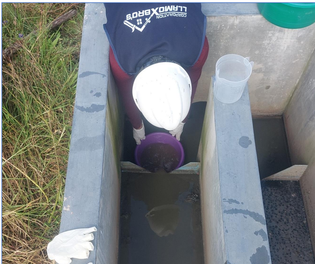
A16. Determinación del tiempo para un recipiente lleno en el aforo volumétrico
