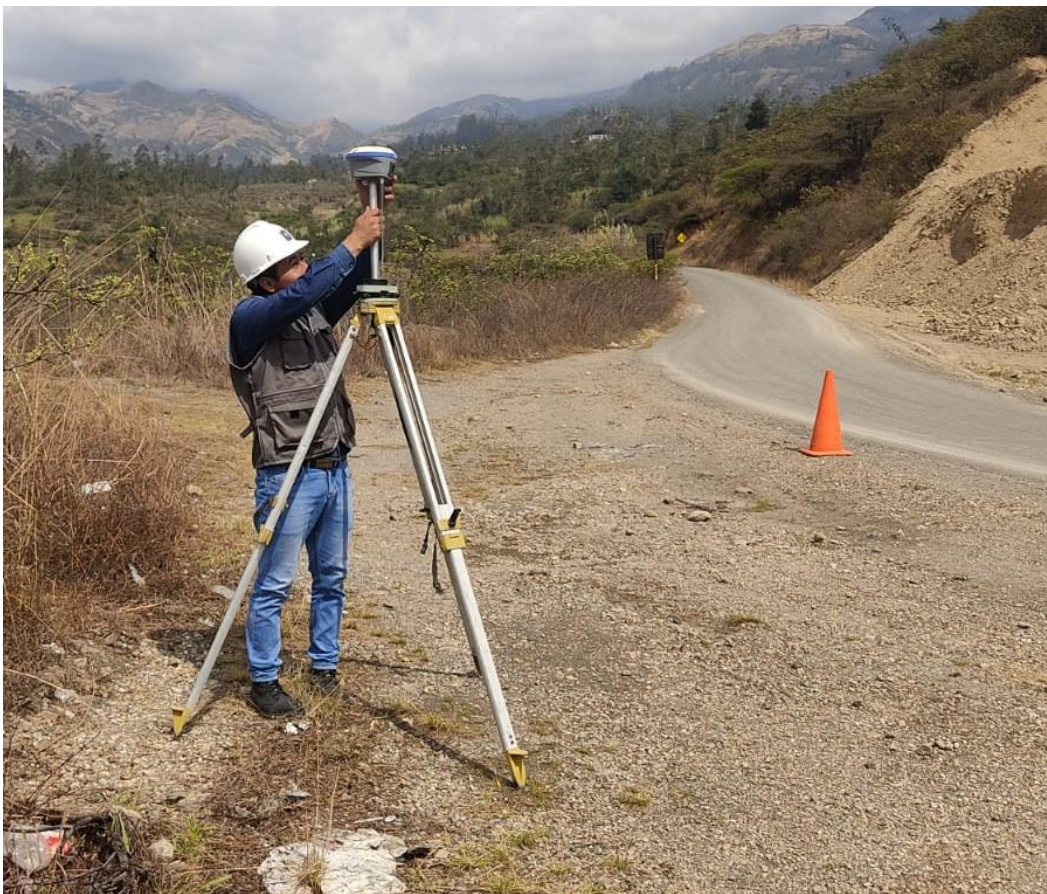
Fotografía N° 09: Estacionamiento del equipo topográfico: GPS Diferencial CHCNAV i90.
