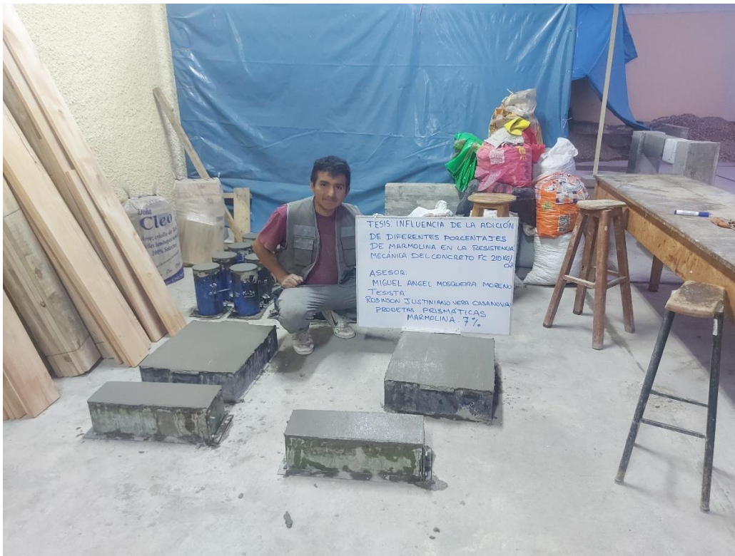
Figura 28. Especímenes prismáticos con adición de marmolina al 7%
