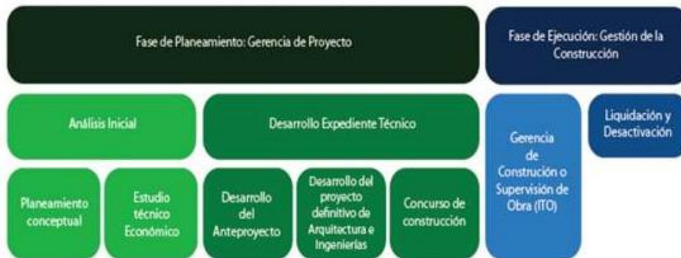
Fases de un proyecto de infraestructura
