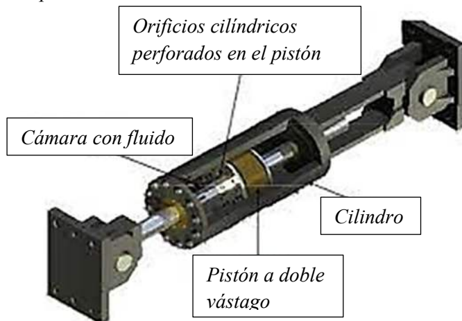
Figura 19 Disipador viscoelástico.
