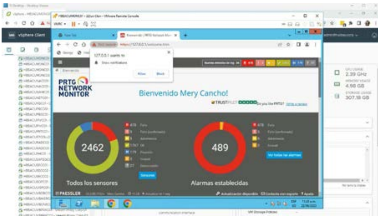
Fig. 49: Consola de PRTG Network Monitor con detalles de los sensores y alarmas establecidas
