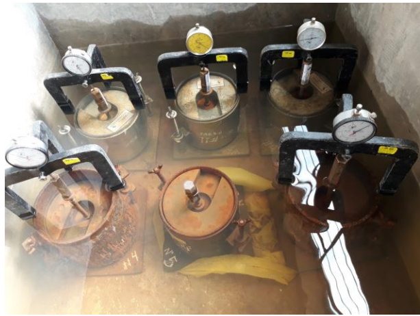
Fotografía 26: Colocación de moldes de CBR en la poza de saturación por 4 días.
