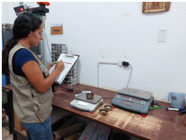
Fotografía 19: Registro de pesos de ensayo limite liquido con adición de ceniza de cascarilla de arroz.
