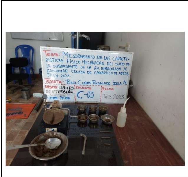
Fotografía 07: Elaboración del ensayo del Limite plástico.
