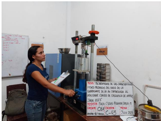
Fotografía 27: Elaboración del ensayo de penetración del CBR, con adición de ceniza de cascarilla de arroz.
