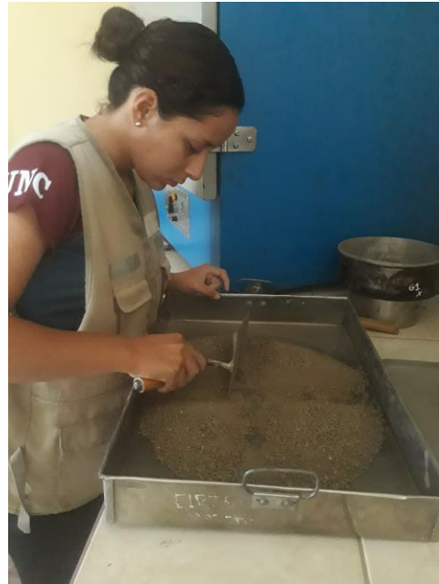
Fotografía 04: Cuarteo de la muestra para el ensayo de límites de atterberg.
