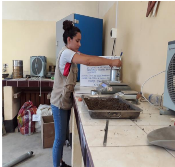
Fotografía 10: Elaboración del ensayo de Proctor modificado, en el cual se está pesando el suelo compactado más el molde.
