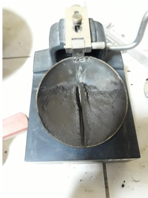
Fotografía 18: Elaboración del ensayo de limite liquido con adición de ceniza de cascarilla de arroz al 11%.
