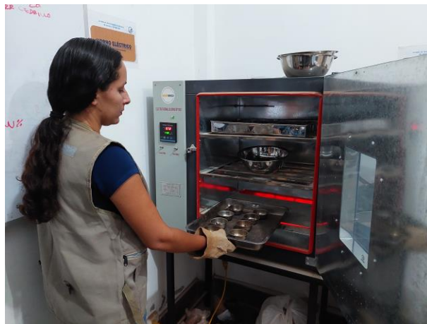
Fotografía 20: Secado de las muestras de límites líquido y plástico.
