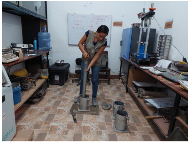
Fotografía 25: Compactado del suelo-ceniza de cascarilla de arroz, para el ensayo de CBR.
