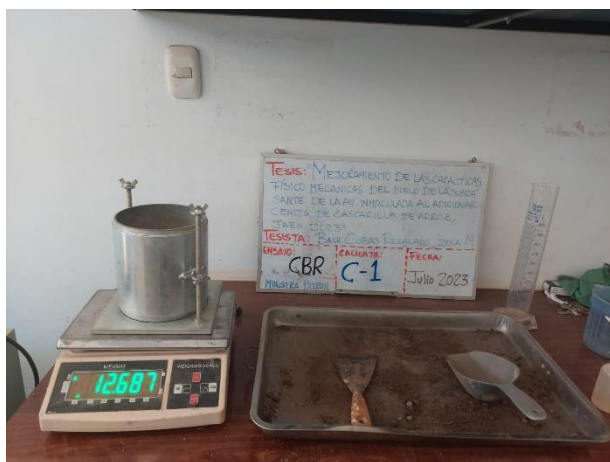
Fotografía 11: Peso del molde con la muestra patrón compactada.
