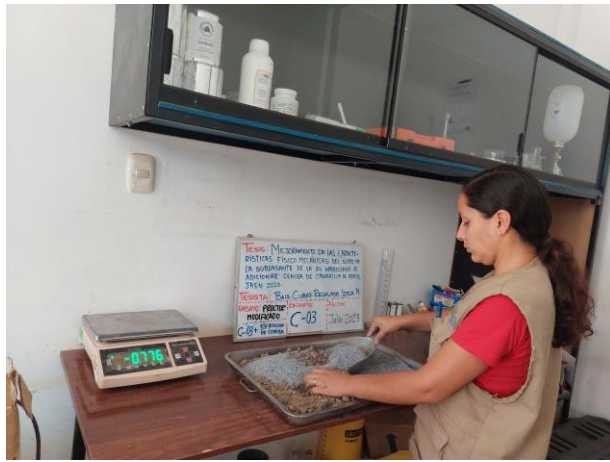
Fotografía 21: Se realiza el mezclado de suelo-ceniza cascarilla de arroz, para el ensayo de Proctor modificado.
