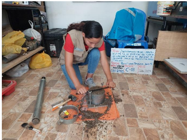
Fotografía 23: Elaboración del ensayo de Proctor modificado, en el cual se está realizando el enrasado de la mezcla suelo-ceniza cascarilla de arroz.
