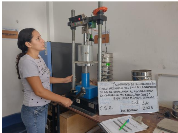
Fotografía 28: Elaboración del ensayo de penetración del CBR, con adición de ceniza de cascarilla de arroz.
