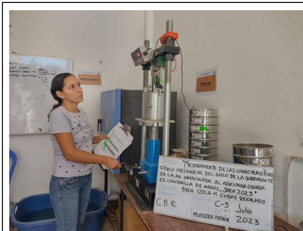
Fotografía 13: Elaboración del ensayo de penetración del CBR, muestra patrón.
