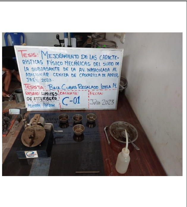
Fotografía 06: Elaboración del ensayo del Limite líquido.
