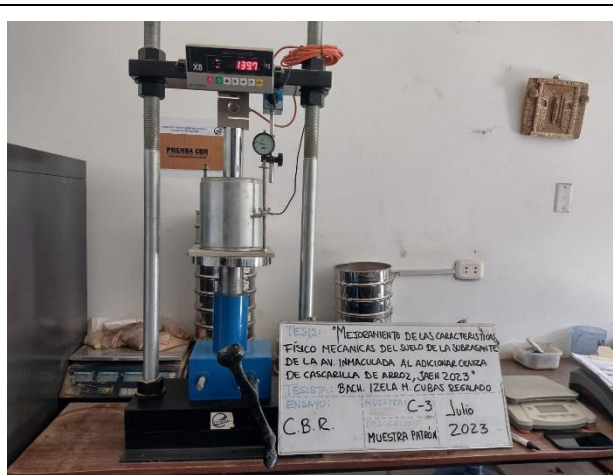
Fotografía 14: Lecturas de las cargas del ensayo de penetración del CBR, muestra patrón.
