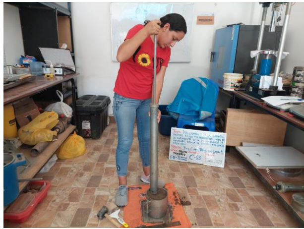
Fotografía 22: Se realiza el compactado de la mezcla suelo-ceniza cascarilla de arroz, para el ensayo de Proctor modificado.
