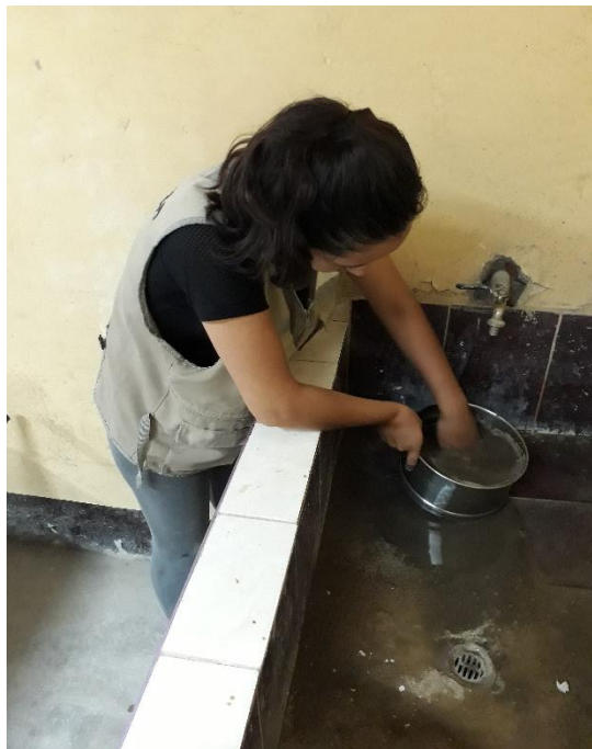
Fotografía 09: Lavado del peso que pasa por la malla N° 200, del ensayo de granulometría.
